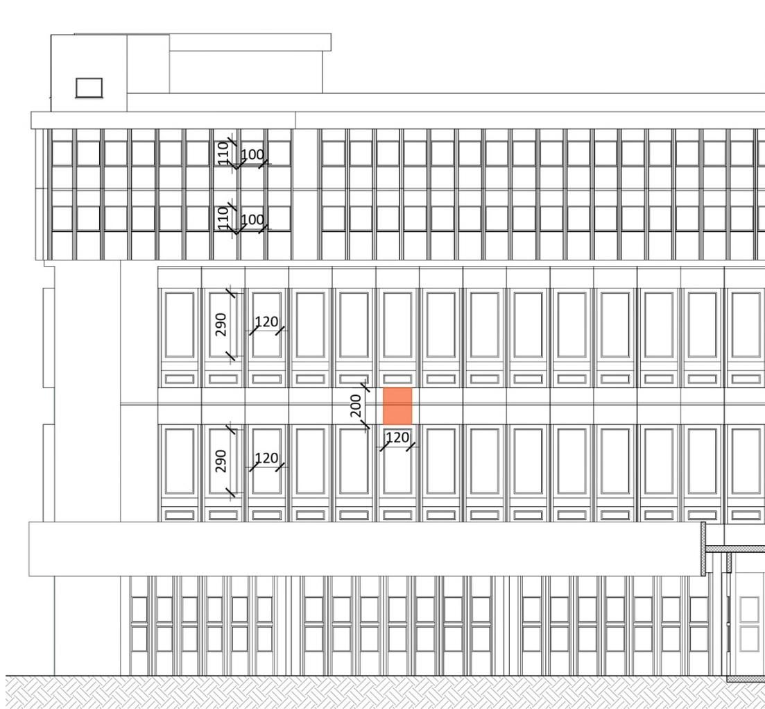
Figura 5-17: Prospetto della facciata analizzata con riferimento alla geometria delle aperture [cm]
