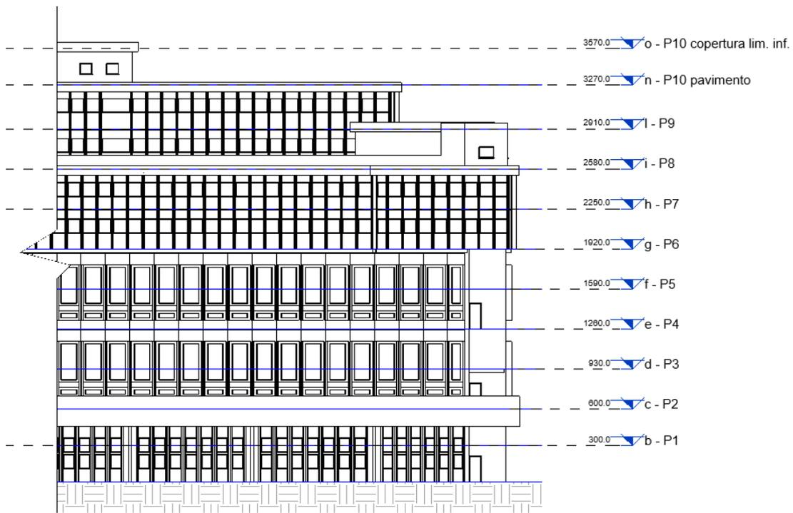
*Figura 5-5: Prospetto Ovest- quote livelli pavimento finito [cm]*
