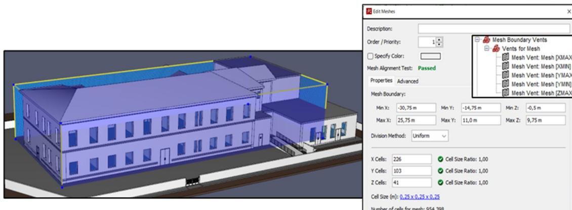
Figura 10 – Definizione mesh di calcolo
