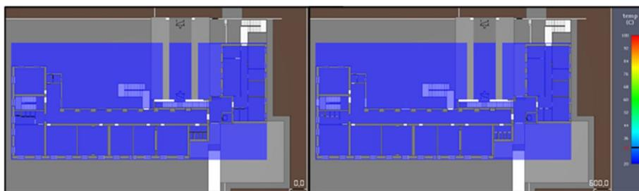
Figura 94 – Slices di temperatura Scenario 5: Quota  $z = 2,0$  m dal calpestio del Piano primo
