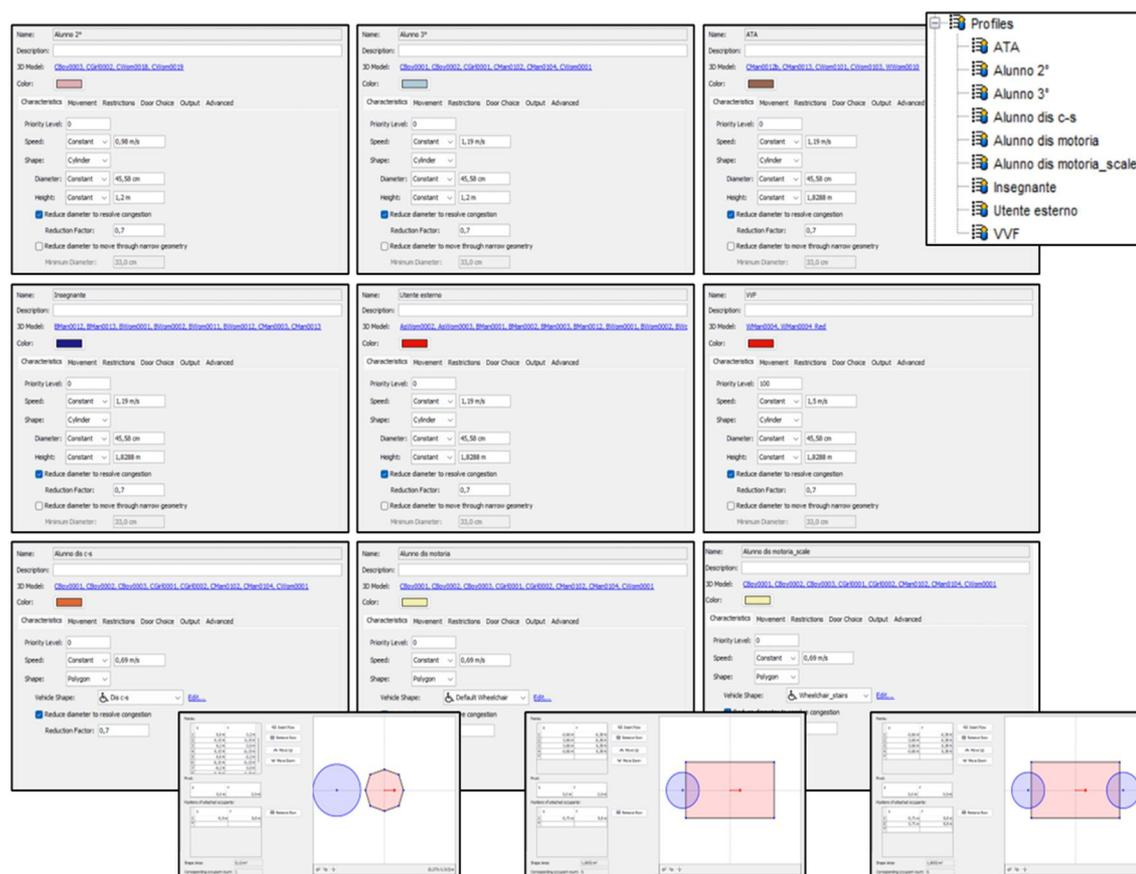
Figura 23 – Definizione profili occupanti
