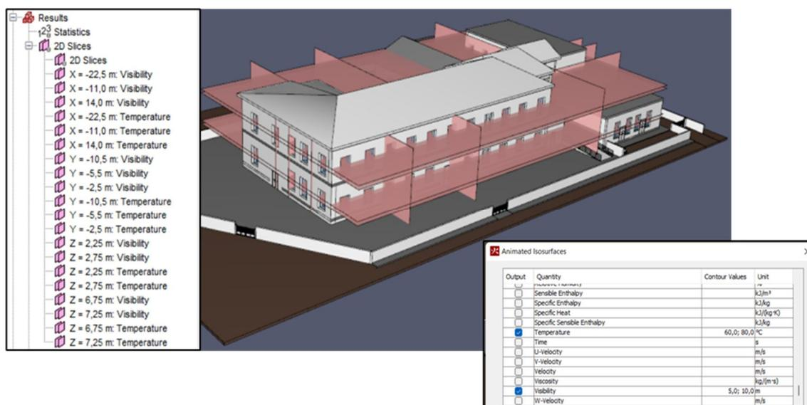
Figura 17 – Localizzazione Slices e Isosurfaces
