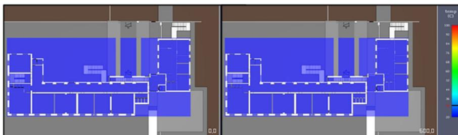
Figura 68 – Slices di temperatura Scenario 3: Quota  $z = 2,0$  m dal calpestio del Piano primo
