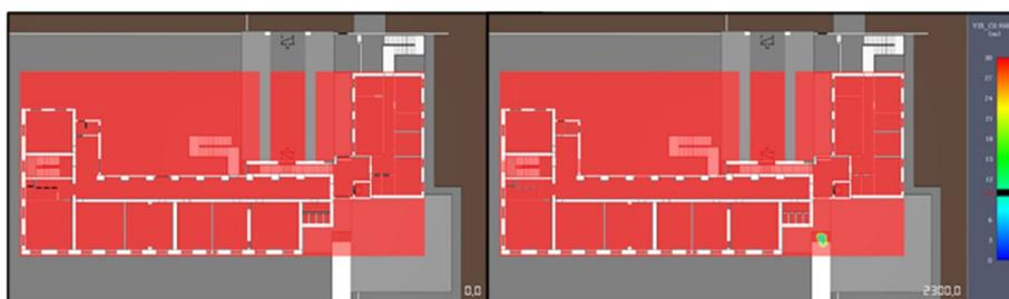
Figura 76 – *Slices* di visibilità Scenario 4: Quota  $z = 2,0$  m dal calpestio del Piano primo
