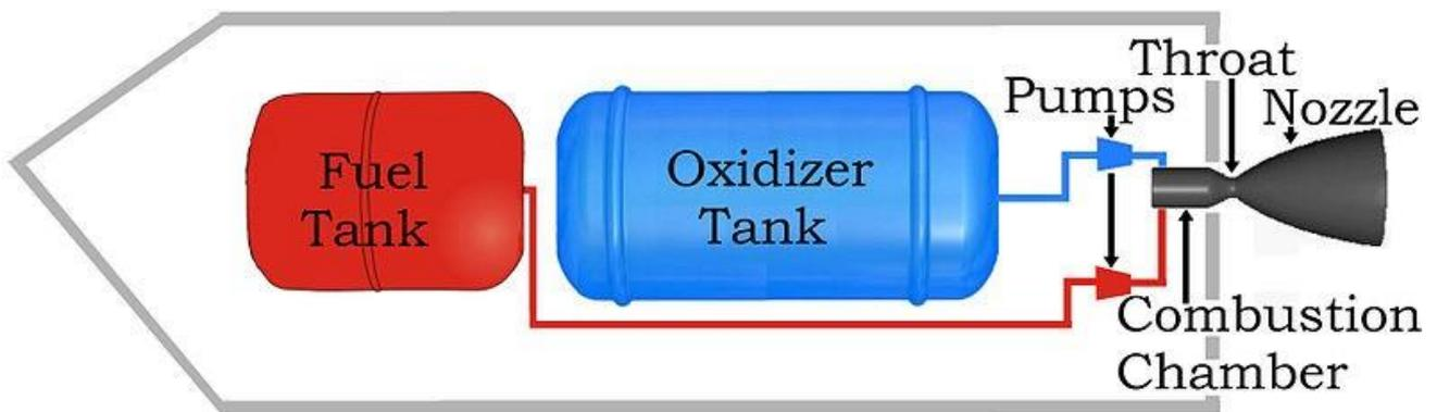
*Figura 3 - Sezione longitudinale di un endoreattore a propellente liquido*
