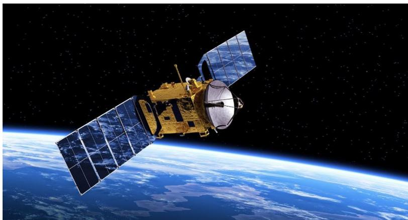
*Figura 23 - Pannelli solari in configurazione dispiegata*
