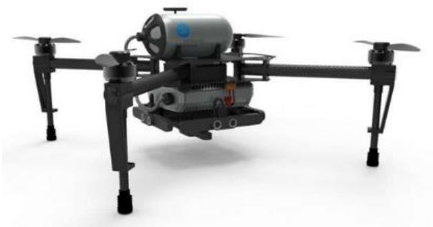
Figura 1 - Esempio di drone alimentato ad idrogeno
