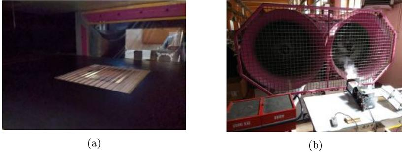
Figura 3.4: (a) Posizionamento della lastra, (b) fan e generatore di fumo
