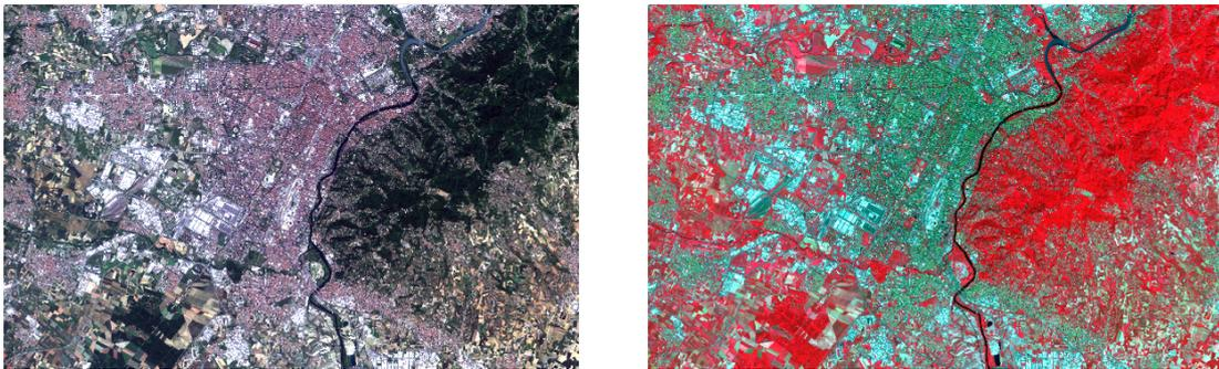
**Figura 2.10:** Immagini generate dalla camera multispettrale del sentinel 2; rgb di Torino a sinistra e a falsi colori a destra
