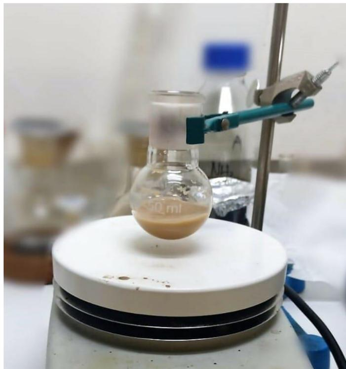
*Fig. 18 Impregnazione ad umido Pd/zeolite Y*
