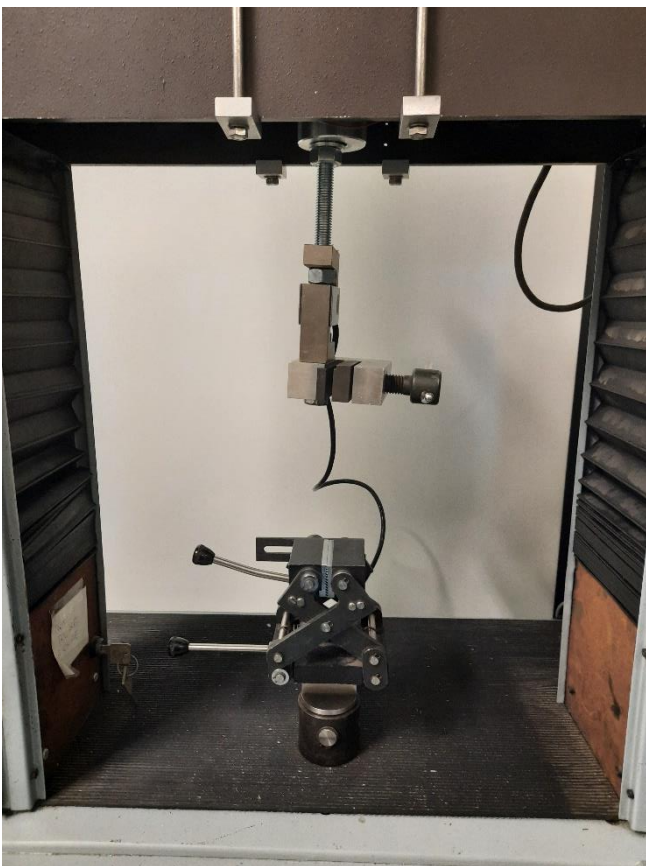
Figura 34. Macchina a trazione utilizzata per il test di peeling.
