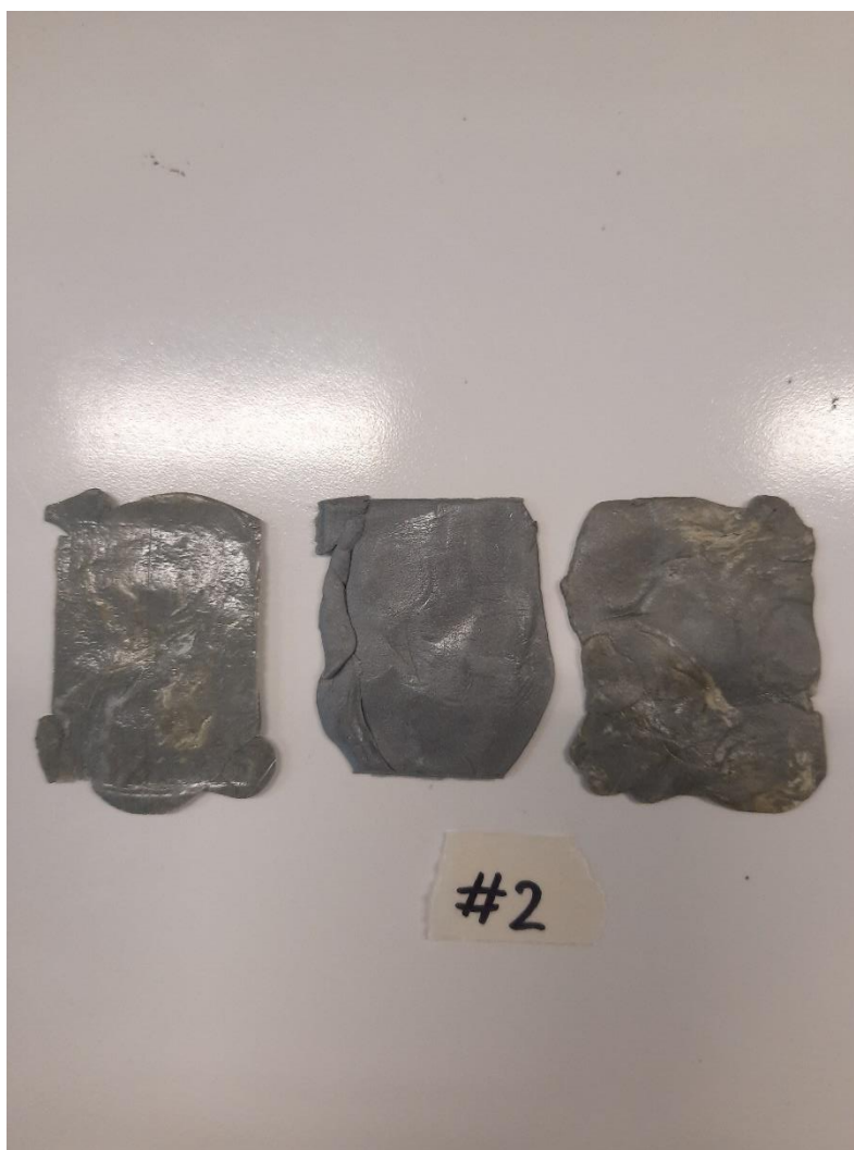
Figura 50. Campione 2 dopo il test di migrazione globale: si evidenziano macchie giallastre dopo il contatto con il simulante.
