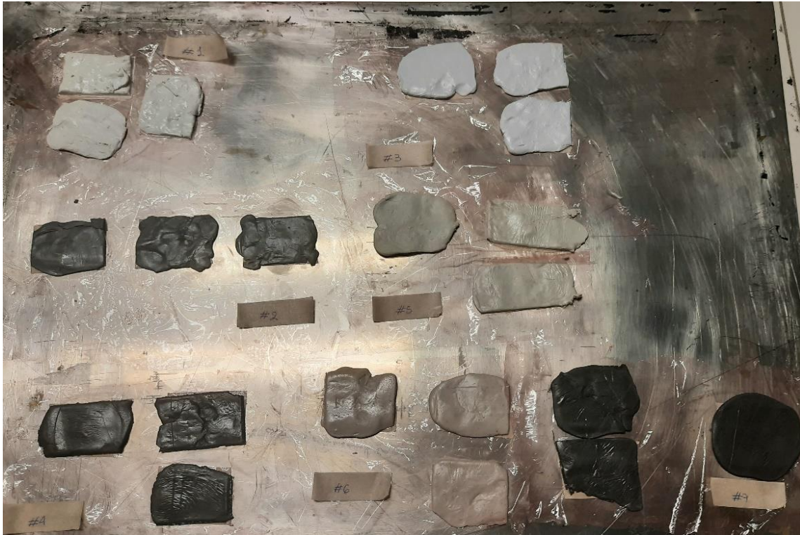
Figura 42. Provini per la prova di migrazione globale delle paste epossidiche.
