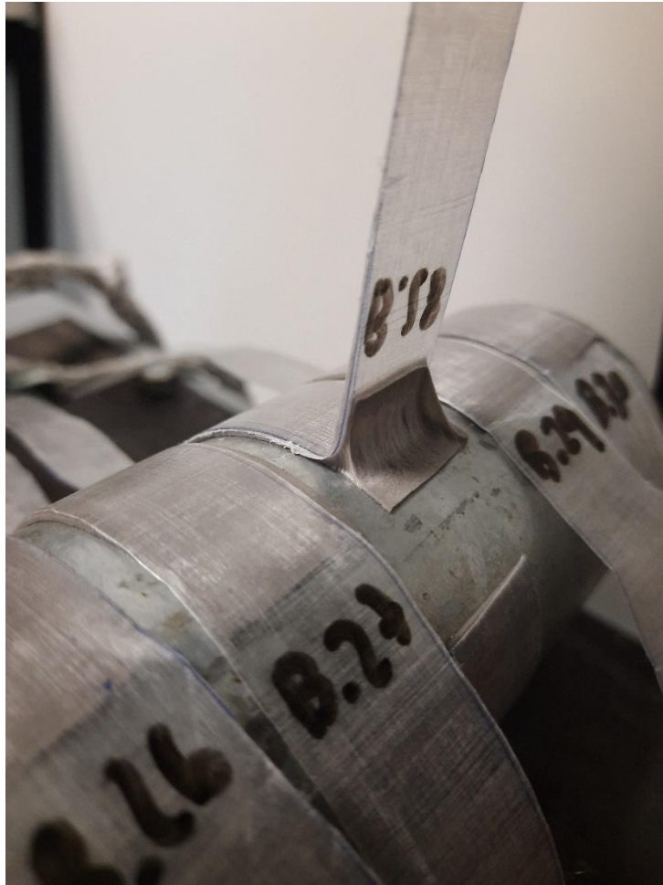
Figura 44. Esempio di inizio di frattura coesiva.
