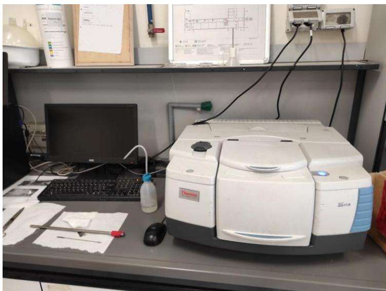
Figura 48: Spettrofotometro FTIR
