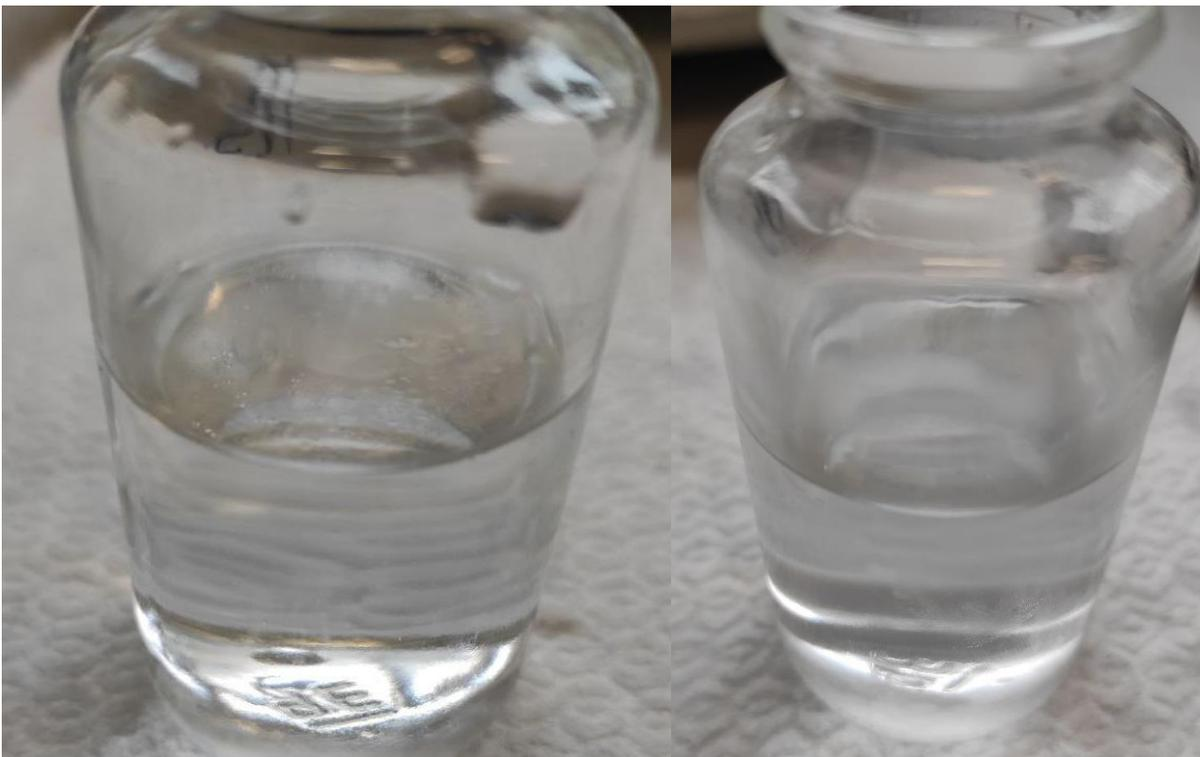
*Figura 66: Miscela acquosa 500 ppm di dodecano prima (a sinistra) e dopo (a destra) il test di adsorbimento*
