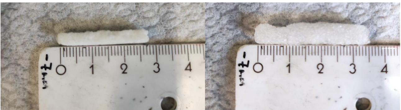
Figura 65: Spugna porosa prima (a sinistra) e al termine (a destra) del test di adsorbimento
