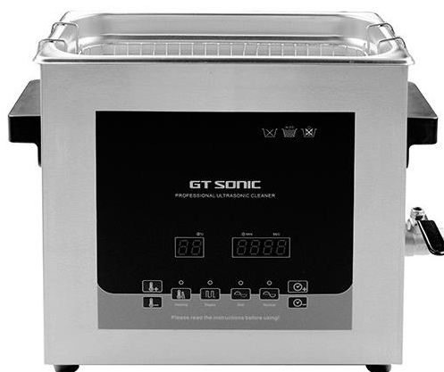
Figura 2.2 Sonicatore GT Sonic Orma utilizzato per disferdere la nanoargilla all'interno delle resine epossidiche
