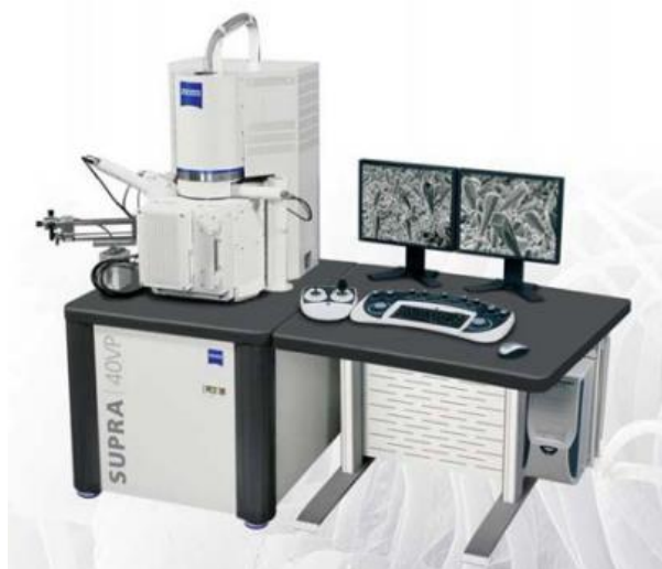
Figura 2.23 FESEM Supra40 con colonna GEMINI e postazione per l'analisi delle immagini (Brochure ZEISS)
