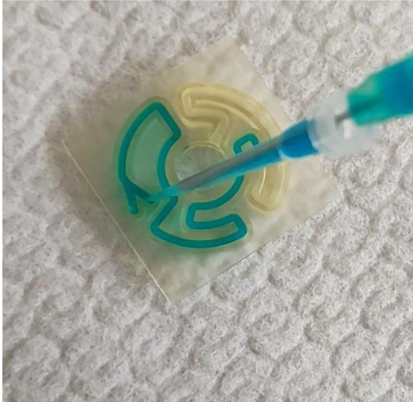
*Figura 6.40: Immagine della base quadrata del dispositivo dalla quale sporge la fluidica. Si può osservare la modalità di caricamento del liquido (soluzione acquosa di colorante "Brilliant Green") che è perpendicolare al piano della base quadrata.*
