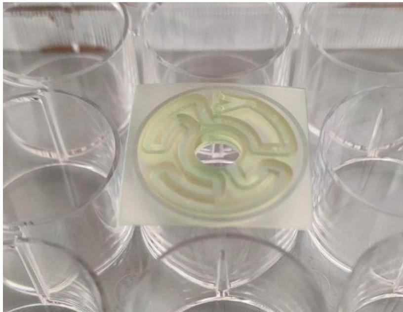
*Figura 6.41: Stampa parziale della prima versione del dispositivo inserita in un pozzetto di una piastra da 12 pozzetti.*
