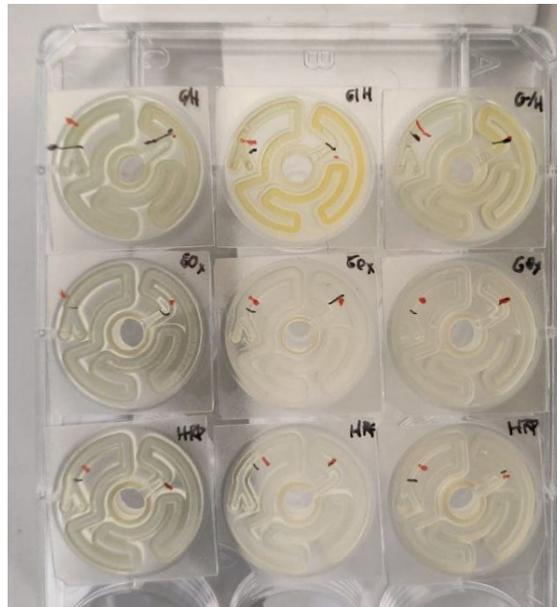
Figura 6.48: Immagine dei dispositivi durante lo sviluppo. I campioni positivi con co-immobilizzate GOx e HRP sono collocati nella prima riga in alto, la seconda riga è costituita da “no HRP”, la terza da “no GOx”.
