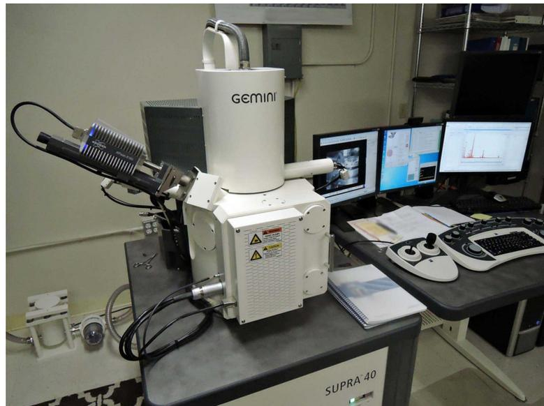
**Figura 3.3:** Microscopio FE-SEM *ZEISS Supra 40* [45].
