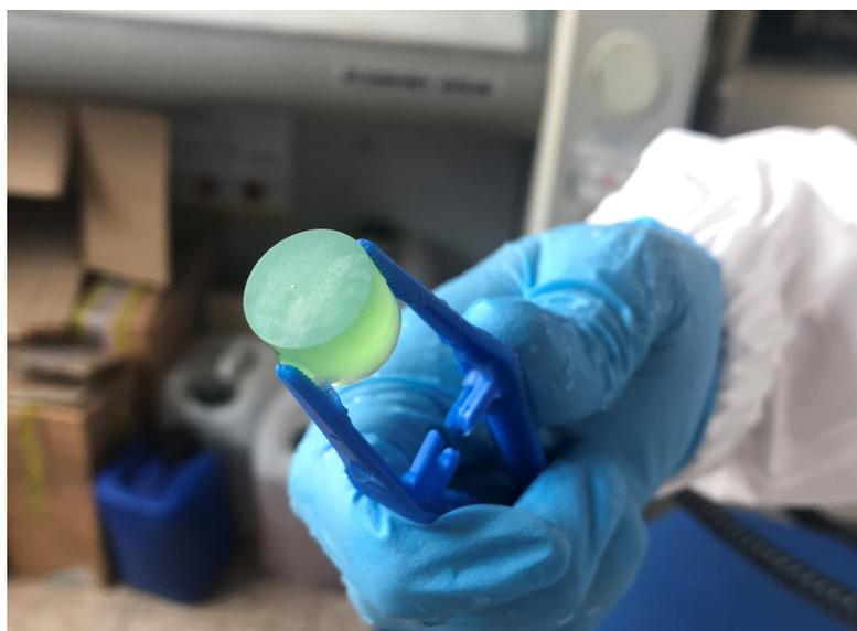
**Figura 3.8:** Campione dopo immersione per 1 secondo nella soluzione acida.
