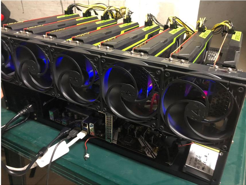
Figura 5.11. Rig: 8 GPU GEFORCE GTX 1080 Ti.
