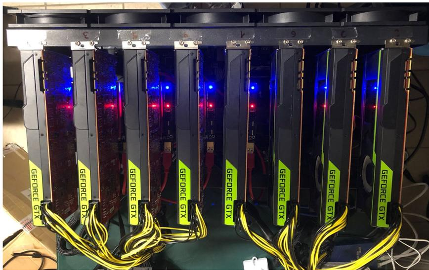
Figura 5.12. Rig: 8 GPU GEFORCE GTX 1080 Ti.
