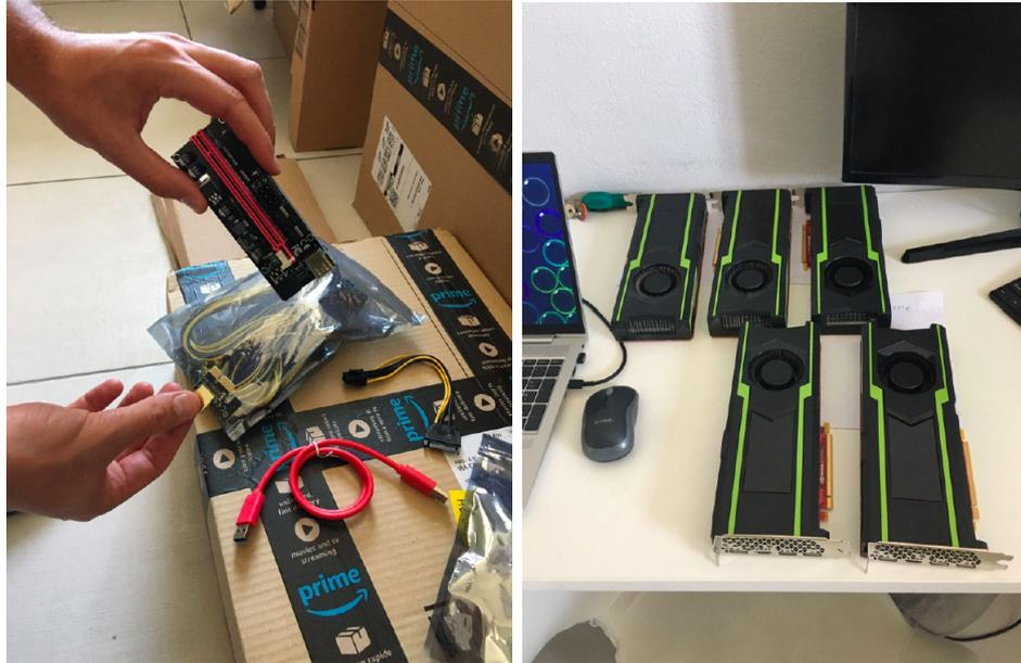
Figura 5.9. Risers e GPU.
