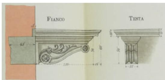
**Figg. 37, 38 e 39** *Balcone sopra l'ingresso, rettangolare con lastra di pietra e modiglioni. Fonte: MCC, Archivio fotografico. / Balcone verso il cortile interno, a ballatoio con ringhiera in ferro battuto. / Dettaglio del modiglione in pietra. Fonte: Musso, G. e Copperi, G. (1912). Particolari di costruzioni murali e finimenti di fabbricati, G. B. Paravia, Torino, tav. IX.*
