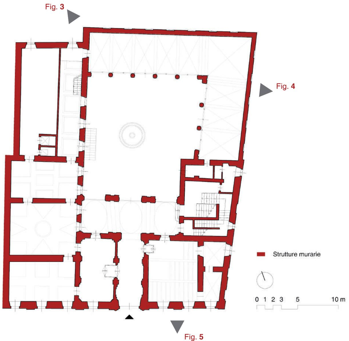
**Fig. 2\_** Individuazione delle strutture murarie nella pianta del piano terreno.
