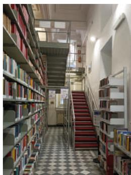
**Fig. 33** \_Scala interna a due rampe, in lamiera piegata.
