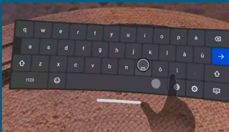
Nella figura 4.7 è presentato un’esempio di utilizzo di hand tracking all’interno di un ambiente virtuale mentre si sta interagendo con la console di comando dell’interfaccia.
