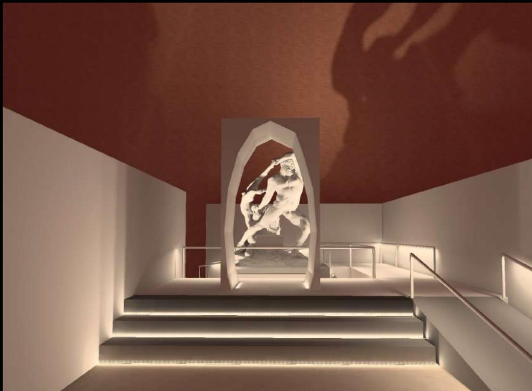
Render realizzato con il software di calcolo Dialux per verificare le scelte illuminotecniche basate sulle esigenze pratiche e stilistiche
