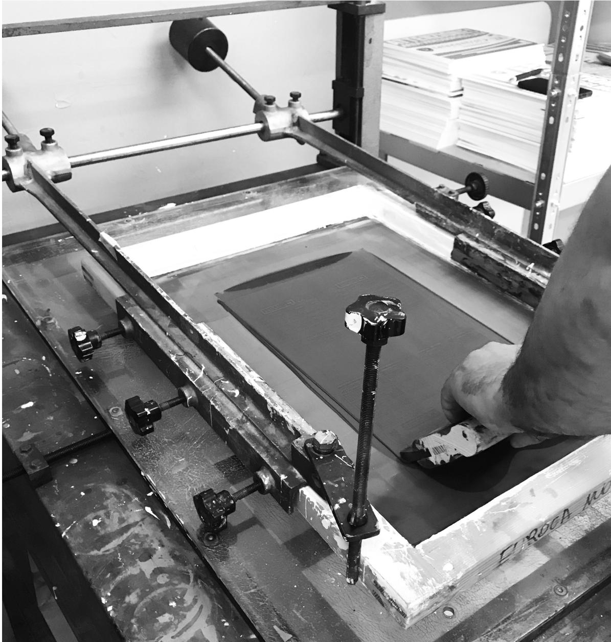
L'inchiostro viene esteso con pressione sul telaio che penetrando si posa sul foglio. Una volta passata la racla la stampa necessita di 24 ore di asciugatura.
