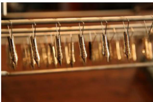
[Fig.122] Strutture per permettere il processo nell'area galvanica
