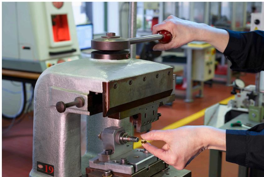
[Fig.118] Coniatura anellino di giuntura metallico
