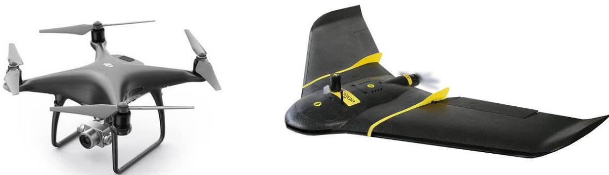
Fig. 17 Esempi di drone quadri-rotore e di drone ad ala fissa. Fonte: (dji.com, 2020); (sensefly.com, 2019)
