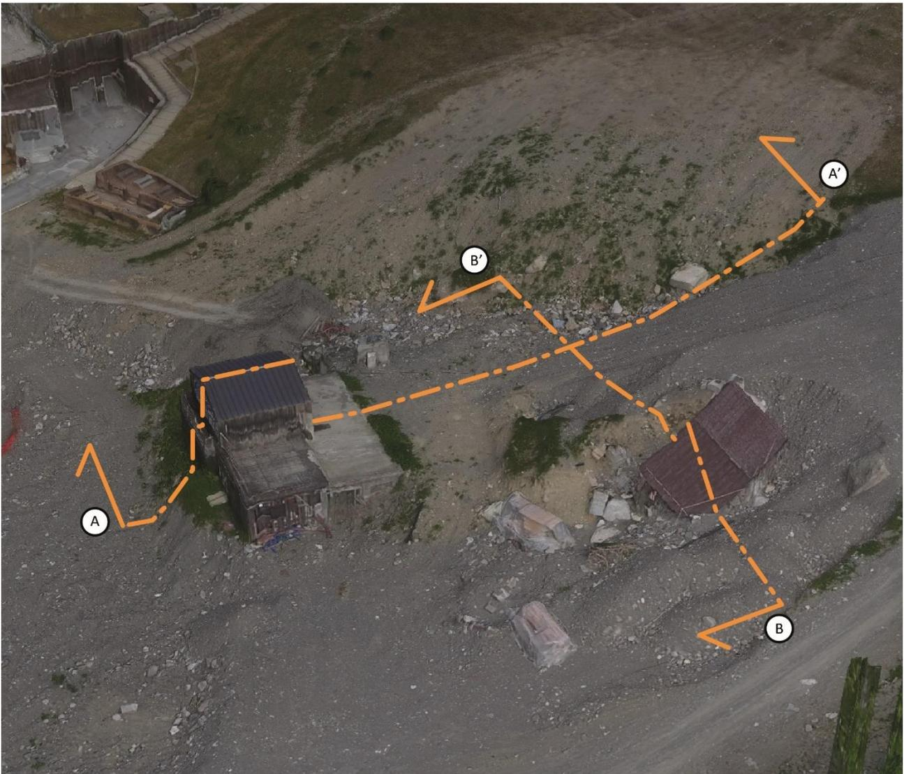
*Fig. 63 Modello geometrico 3D texturizzato dell'area di Limonetto (21/06/2021) e linee di sezione*
