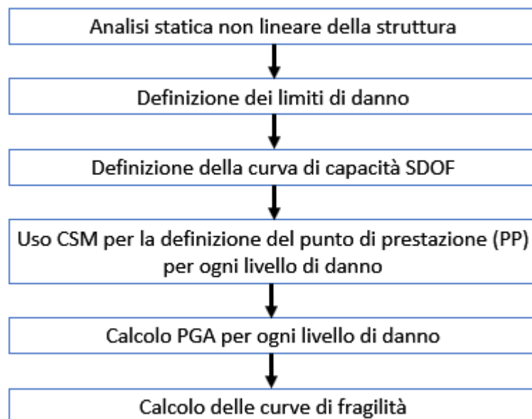
Figura 31: Diagramma di flusso per la definizione delle curve di fragilità
