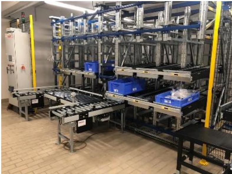
*Figura 5.1 – Magazzino AS/RS presente nel laboratorio del DIGEP*
