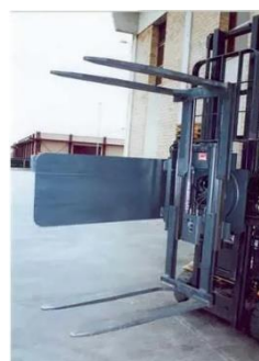
Figura 23.4b Carrello ruotafalde, particolare delle forche
