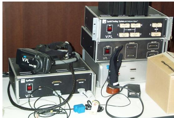
**Figura 2.12:** Device della VPL, tra cui DataGlove ed Eyephone, [21]
