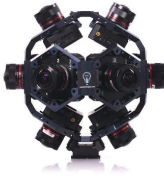
**Figura 2.38:** Esempio di camere montate in una struttura personalizzata, [61]
