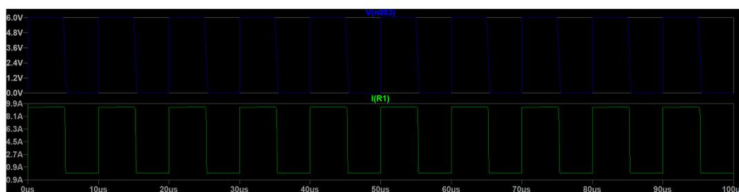
Figura 5.15: Corrente di uscita e segnale di controllo per un valore di frequenza di 100 kHz
