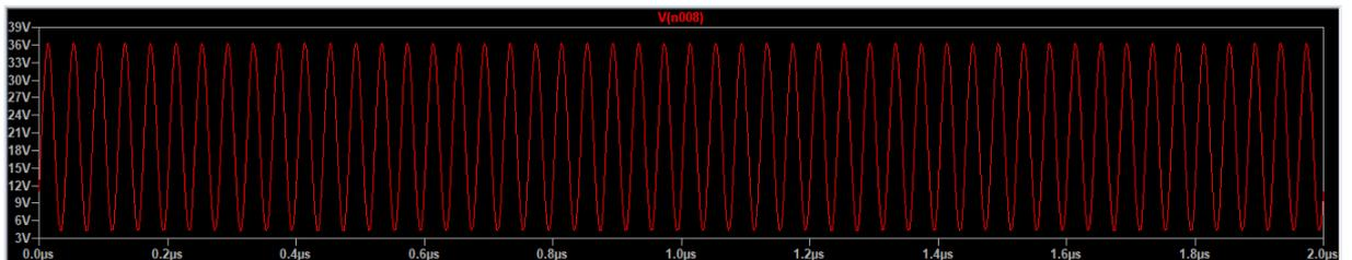
Figura 5.42: Andamento della tensione di uscita per un valore di  $C_5$  di 1 pF
