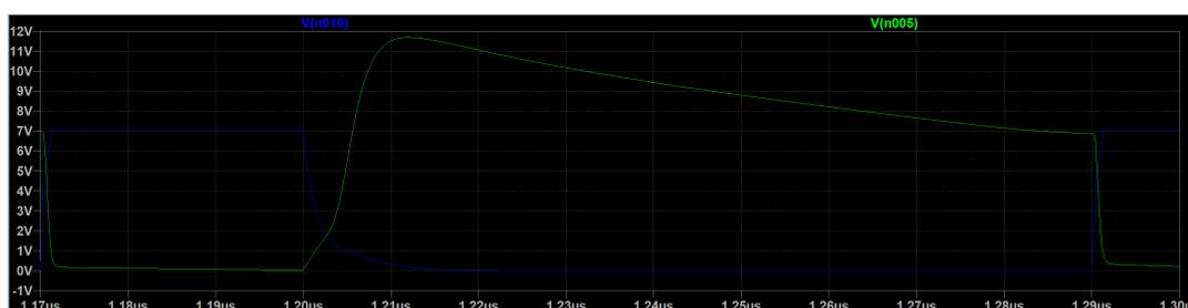
Figura 5.64: Segnali di controllo dei due GaN di potenza a seguito del dimensionamento
