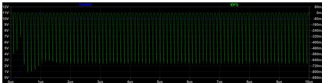
Figura 5.63: Assorbimento della corrente del generatore e andamento della tensione di uscita del convertitore a mezzo ponte per un valore delle resistenze di blanking di 20 kOhm
