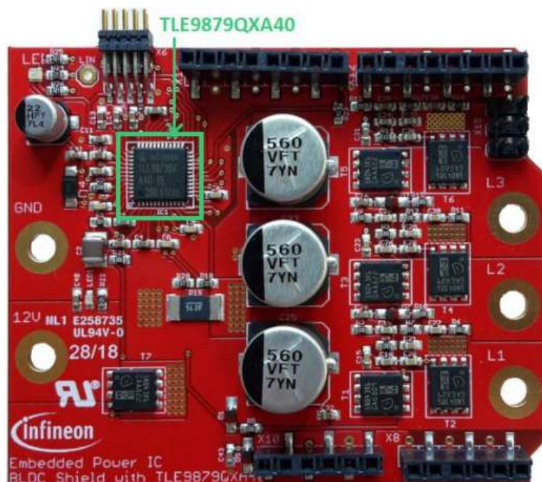
Figura 4: Shield di Arduino Infineon TLE9879QXA40
