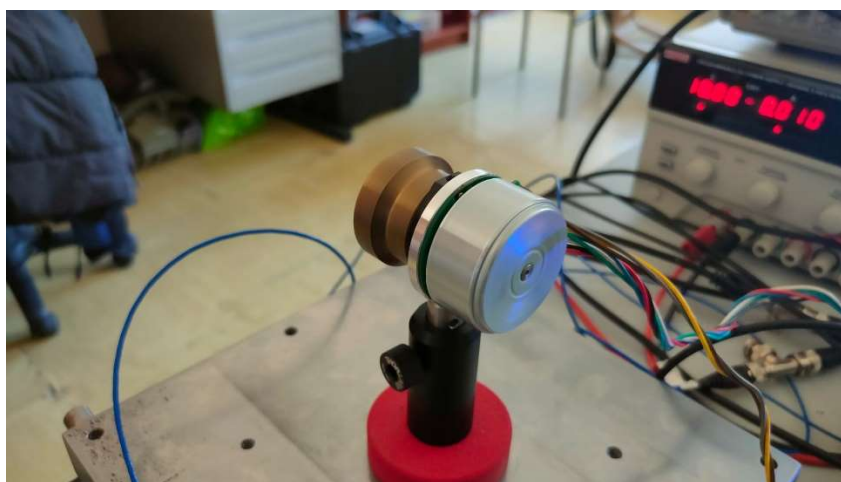
Figura 19: Motore BLDC montato sulla piattaforma inerziale con un supporto magnetico
