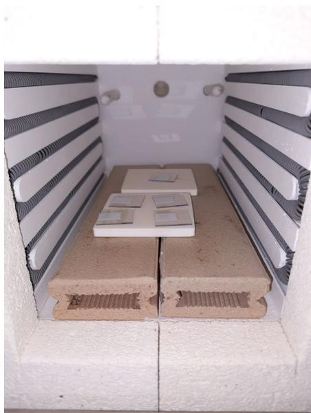
Figura 1.11: Fotoanodi prima del processo di Sinterizzazione
