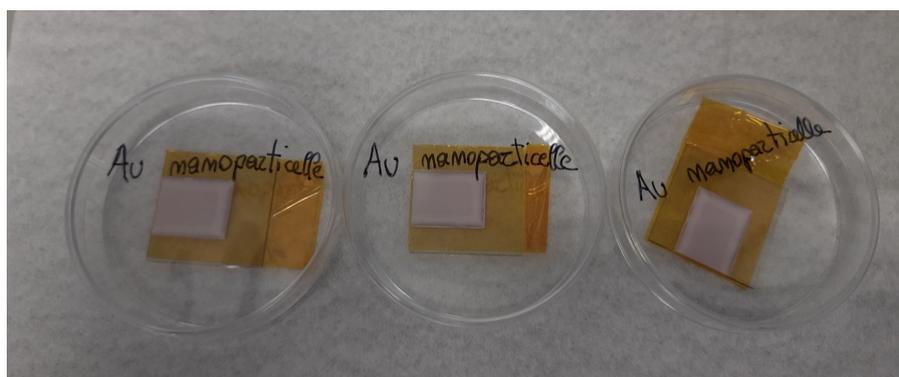
Figura 1.17: Fotoanodi dopo essere stati immersi un notte nelle nanoparticelle d'oro a cui è stato aggiunto il tape
