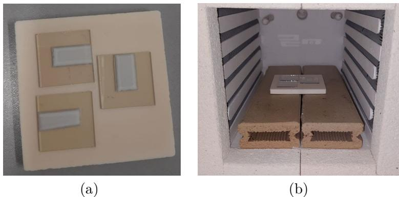
Figura 1.10: Fotoanodi pronti per il processo di Sinterizzazione
