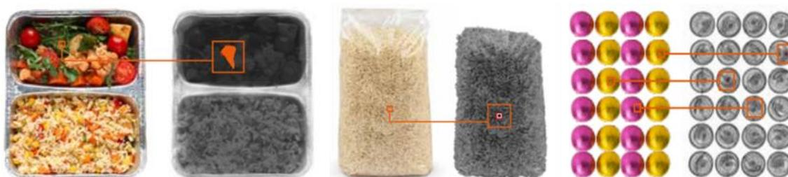
**Figura 5.10** - Esempi di rilevazione di sostanze contaminanti (frammenti metallici, ossei, in ceramica, vetro, plastica o gomma) da parte di un sistema a raggi X all'interno di un vassoio di cibo confezionato (a sinistra), un pacchetto di riso (al centro) e dei cioccolatini incartati (a destra)
