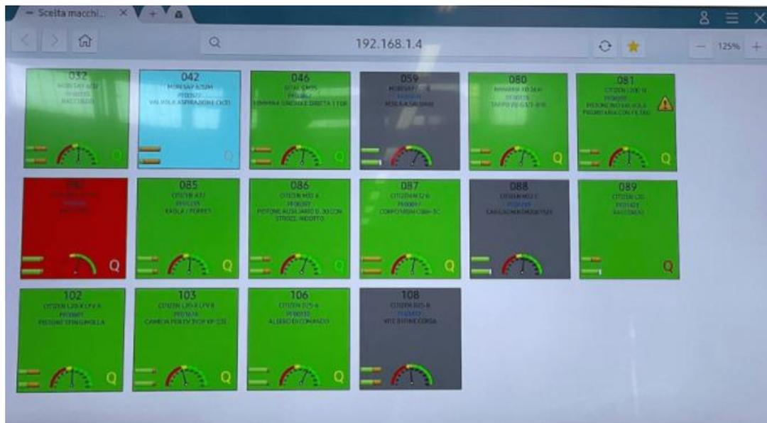
**Figura 2.1** - L'immagine illustra l'interfaccia del MES I-Man sfruttata dalla società di torneria e meccanica di precisione Primamec per la visione d'insieme del parco-macchine: lo stato operativo di ciascun macchinario ispettivo ("in funzione", "in attesa del controllo qualità", "in fase di attrezzaggio" o "fermo") si evince dall'utilizzo di differenti colorazioni del box grafico ad esso dedicato
