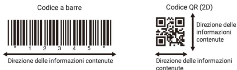
**Figura 3.10** - L'estensione di codifica bidimensionale propria dei codici QR rende la loro capacità di memoria informativa maggiore rispetto a quella di un codice a barre di pari ingombro
