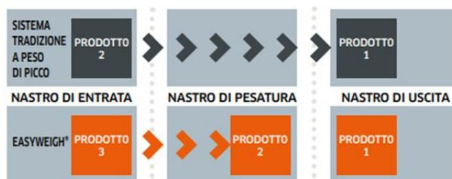
**Figura 5.3** - Minor intervallo spaziale tra gli articoli sul nastro trasportatore consentito dall'approccio di pesatura basato sul peso medio (in basso) rispetto a quello tradizionale basato sul peso di picco (in alto)
