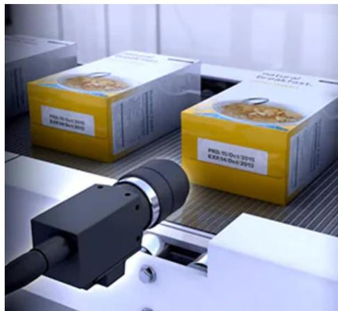
**Figura 3.12** - Utilizzo di dispositivi di visione OCR per la lettura e digitalizzazione automatica delle informazioni in forma testuale impresse su articoli e package
