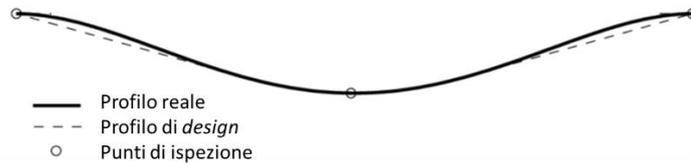
**Figura 6.4** - Discrepanza tra profilo reale e profilo di design dell'oggetto che sfugge al controllo discreto effettuato da una CMM su soli tre punti di misurazione
