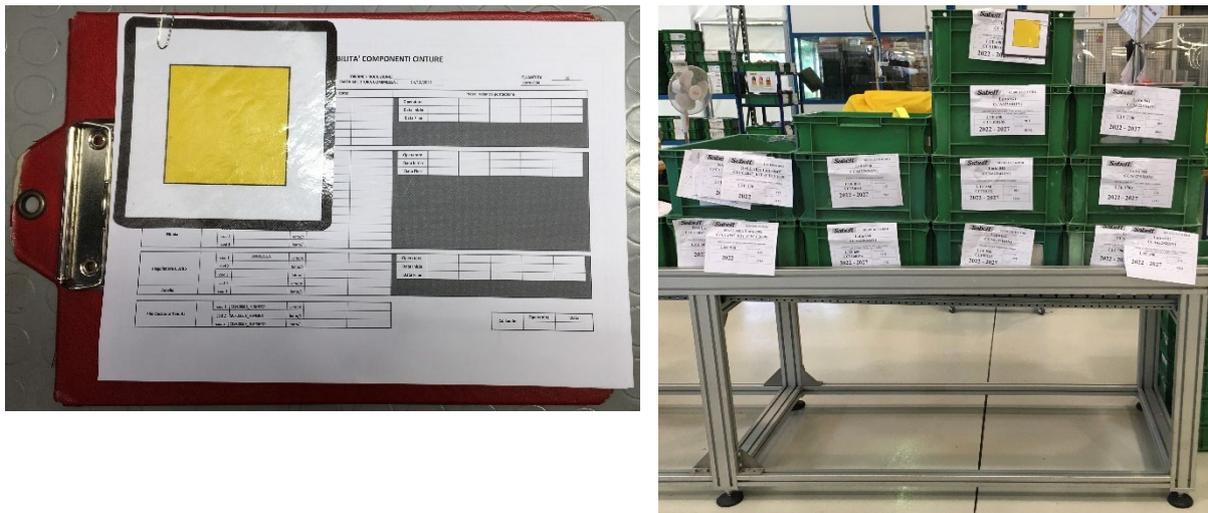
**Figura 4.14:** Implementazione sulla linea cinture degli strumenti tipici del *Visual Management*.
