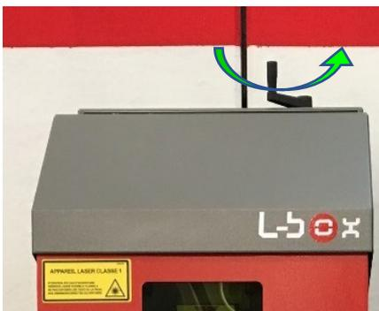
**Figura 5.4:** Manovella della marcatrice laser per la regolazione della messa a fuoco.
