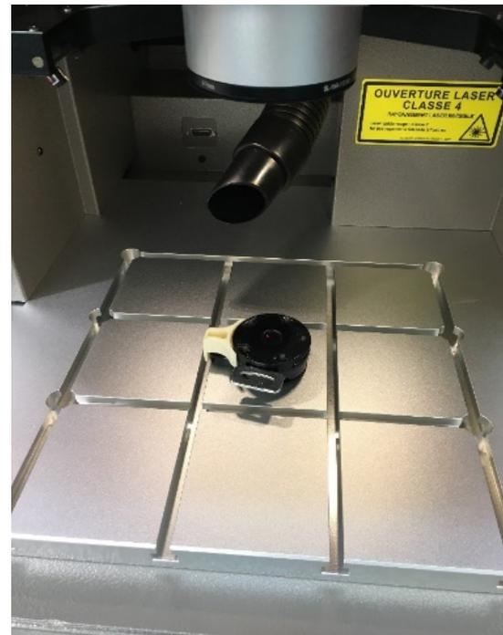
**Figura 5.5:** Vista dell'operatore sull'area di lavoro durante la marcatura a laser del componente metallico.
