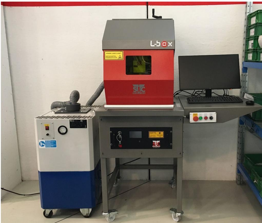
**Figura 5.2:** Marcatrice laser collegata ad un'interfaccia PC e ad un aspiratore per evitare la diffusione di polveri durante le lavorazioni.
