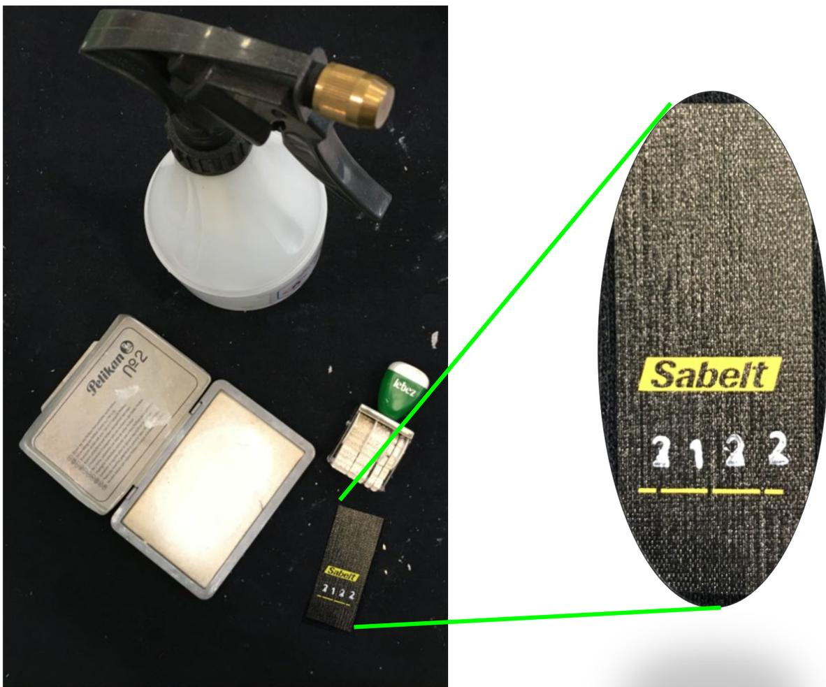
**Figura 5.6:** Sistema attualmente impiegato per marcare e identificare le cinture *CLUBMAN* tramite timbratura.
