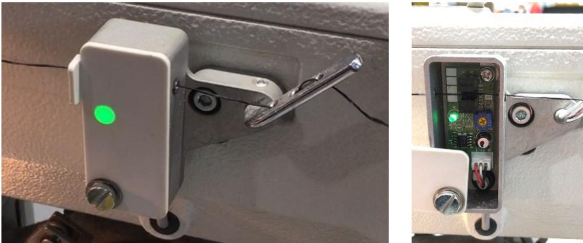
**Figura 4.20:** Centralina per rilevare la presenza del filo superiore durante la cucitura.
