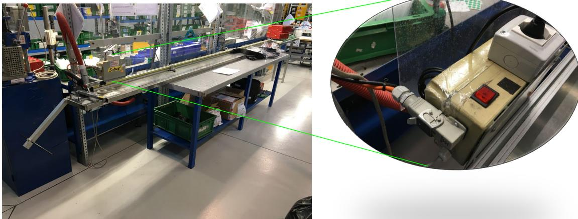
**Figura 3.30:** Centralina elettrica banco di taglio secondario.
