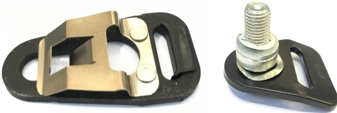
*Figura 4.19: A sx il nuovo componente progettato in sostituzione della staffa con la minuteria illustrato a dx.*
