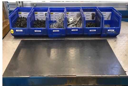
*Figura 4.5: Casette della minuteria predisposte sulla postazione per l'assemblaggio delle fibbie.*
