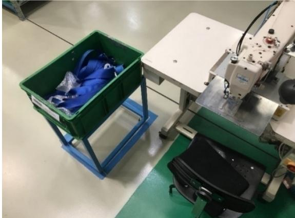
**Figura 4.15:** Zoning per identificare la posizione in cui porre il carrello a lato delle postazioni di cucitura.
