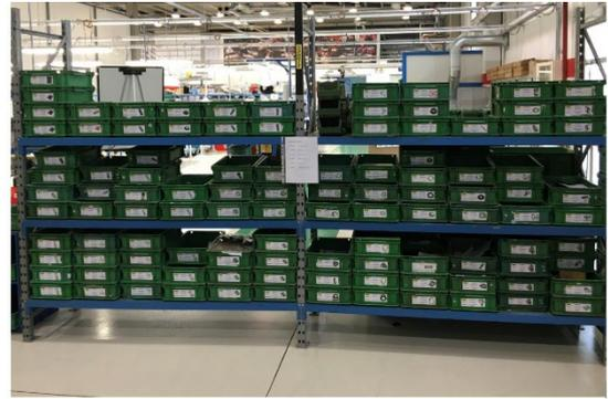
*Figura 4.9: Implementazione della terza S sulla scaffalatura per la minuteria delle cinture.*
