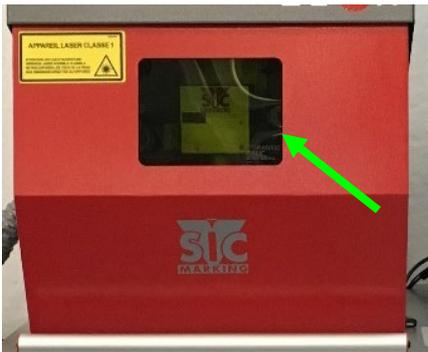
**Figura 5.3:** Pannello protettivo ricavato sullo sportello della marcatrice laser.
