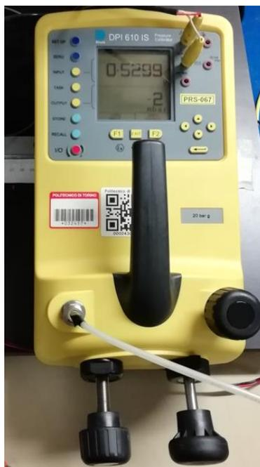
**Figura 3-9 Calibratore di pressione**
