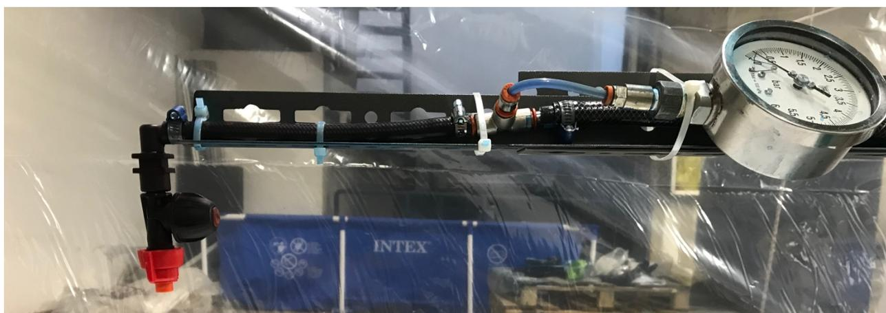
*Figura 3-8 Dettagli del banco prova: manometro e ugello*
