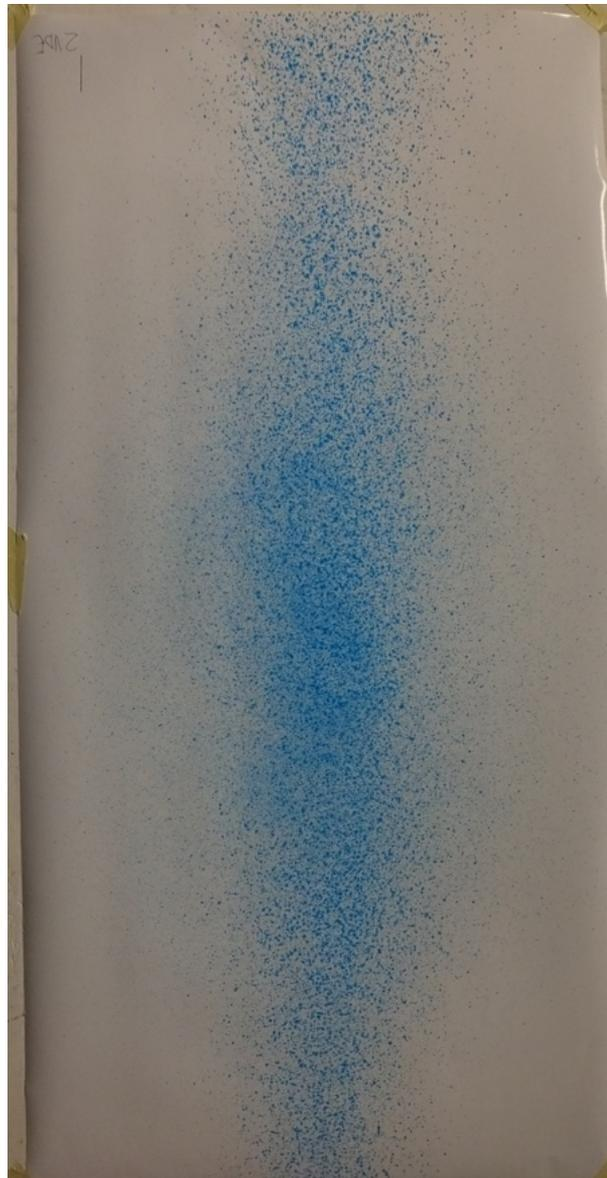
*Figura 6-6 Prova con circuito con vaso di espansione, pressione di irrorazione 2 bar, ugello WRC110015*
