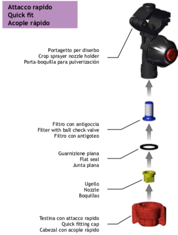
Figura 3-14 Montaggio ugello [4]
