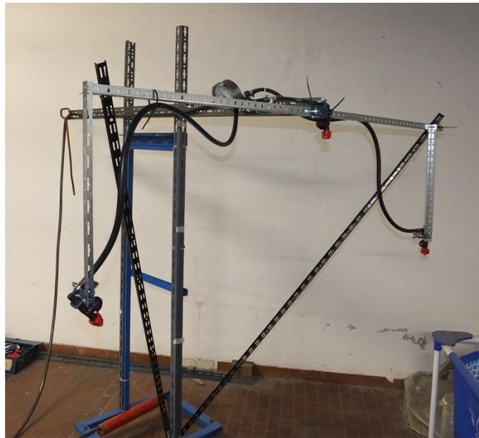
*Figura 5-1 Circuito idraulico a tre ugelli*
