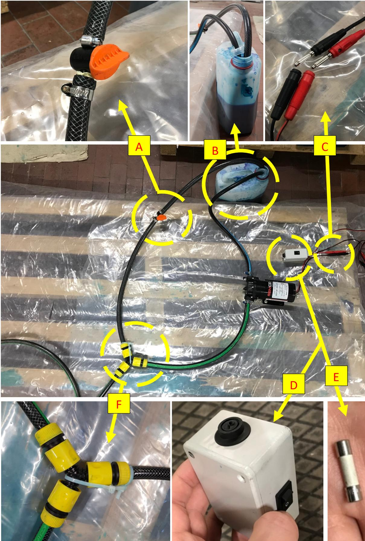
Figura 3-5 Circuito idraulico a monte dell'ugello e dettagli dello stesso
