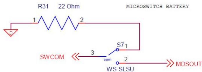
Figure 5.48: Switch wurth 450405020524 schematic
