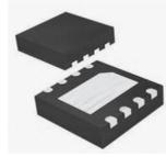
Figure 5.12: Gauge module MAX17048
