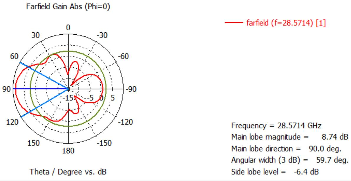
Fig. 4.64: Farfield Gain Abs ( $\Phi=0$ )
