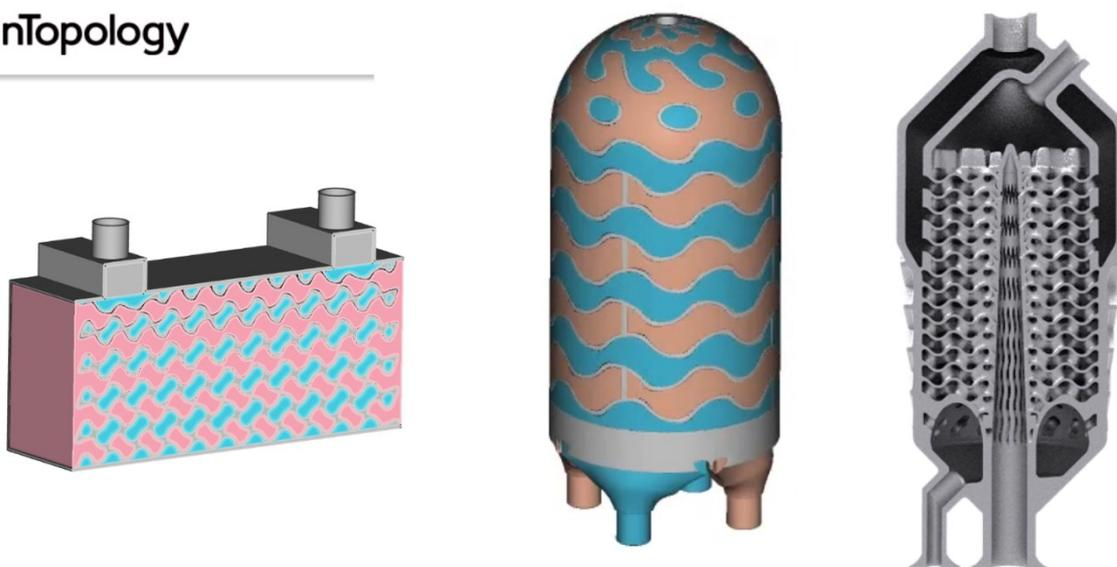
*Figura 155 – Esempi di applicazioni termiche delle TPMS negli scambiatori di calore*
