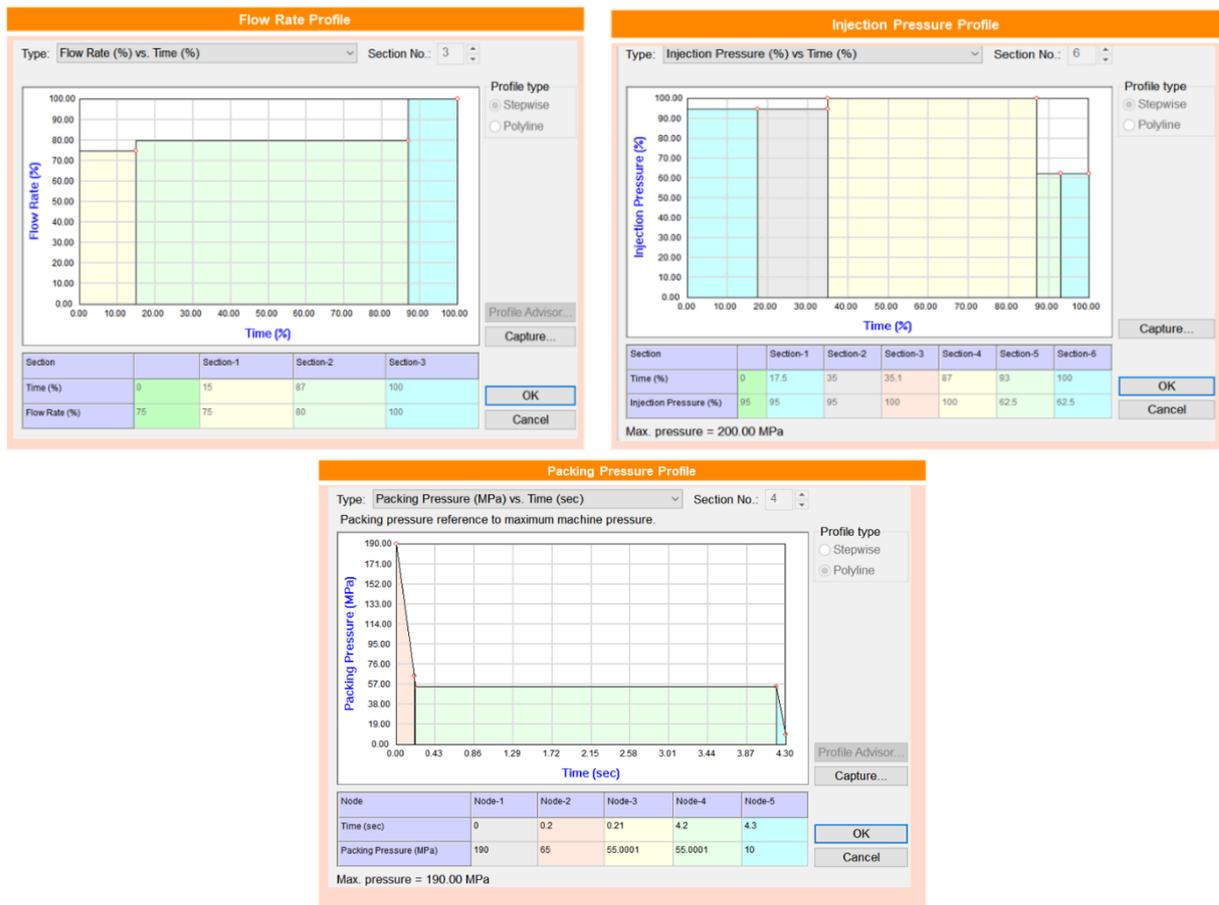
Figura 96 – Profili di iniezione e mantenimento adoperati nella simulazione Moldex3D
