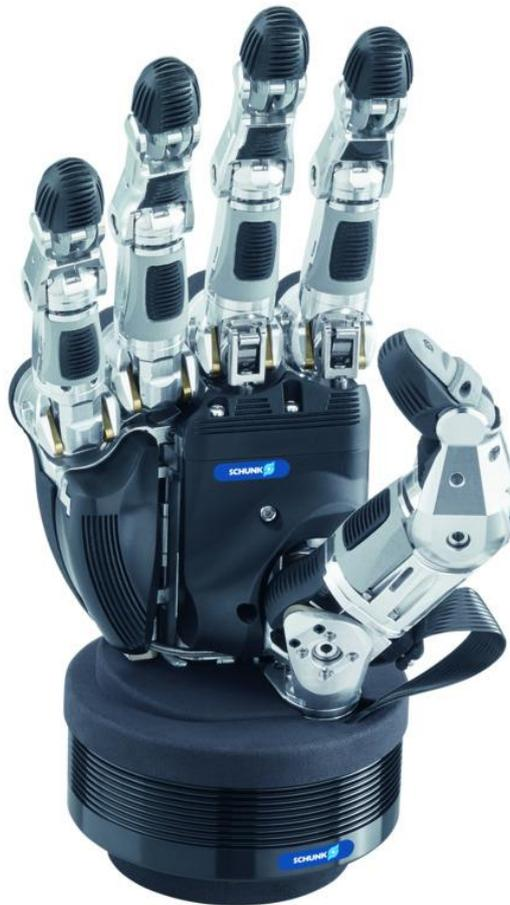
*Figura 17: esempio di mano antropomorfa robotica sviluppata da "SCHUNK" [8]*
