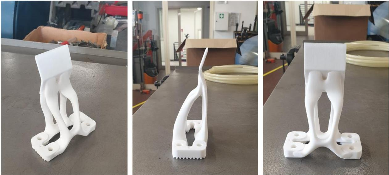
*Figura 81: Prototipo realizzato in PA12 con tecnica SLS*
