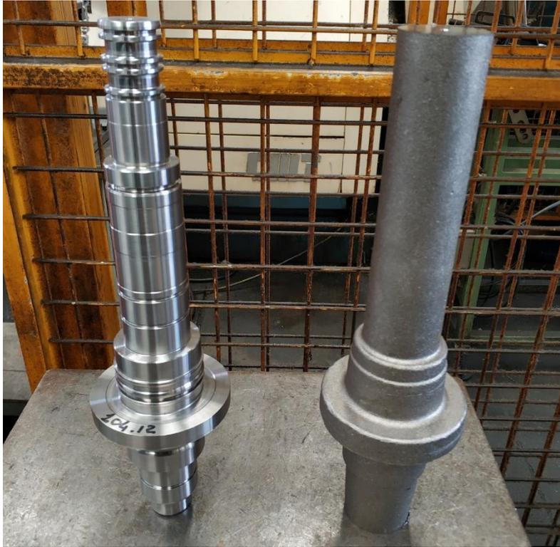
Figura 37: albero di trasmissione prima e dopo la lavorazione di tornitura
