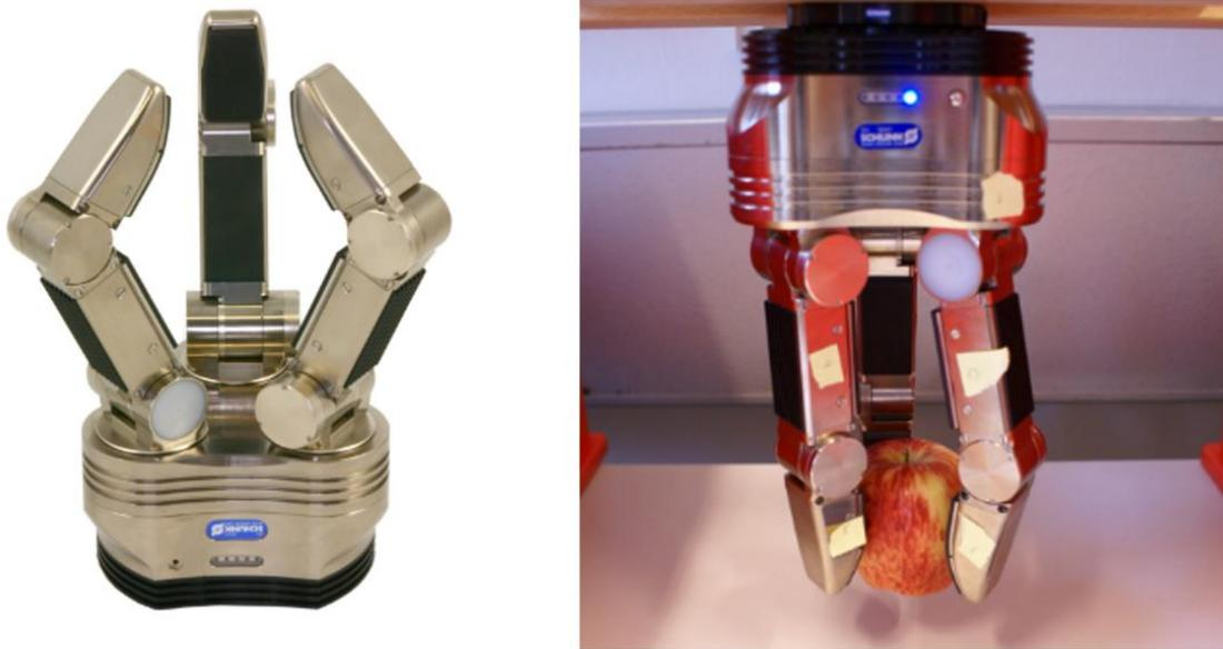
Figura 22: Pinza angolare con tre griffe con un esempio di presa adattativa [12]
