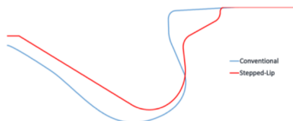
Figura 4.4 Profilo del pistone convenzionale (RE) e stepped-lip (SL)
