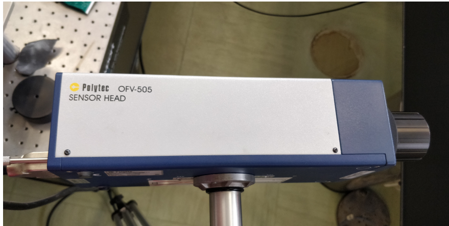
Figura 2.13: Polytec OFV-505 montato su un treppiede utilizzato per la valutazione degli effetti sistematici lungo tre assi.
