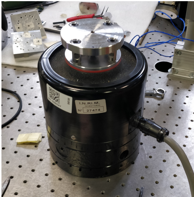
Figura 2.8: Shaker elettrodinamico Modal Shop 2075E.
