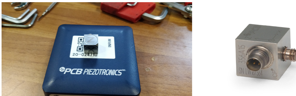
Figura 2.10: PCB 356A15. Nella figura a destra è visibile il perno filettato che permette il fissaggio dell'accelerometro alla superficie di cui si vuole conoscere l'accelerazione e il connettore 1/4-28 4 pin che permette di collegamento con il condizionatore di segnale.
