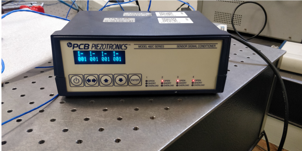
Figura 2.5: PCB 482C. In questo condizionatore è possibile variare valore e tipo di guadagno, sensibilità, scala di input e output, tipo di input ed eventualmente impostare dei filtri sia in entrata che in uscita.
