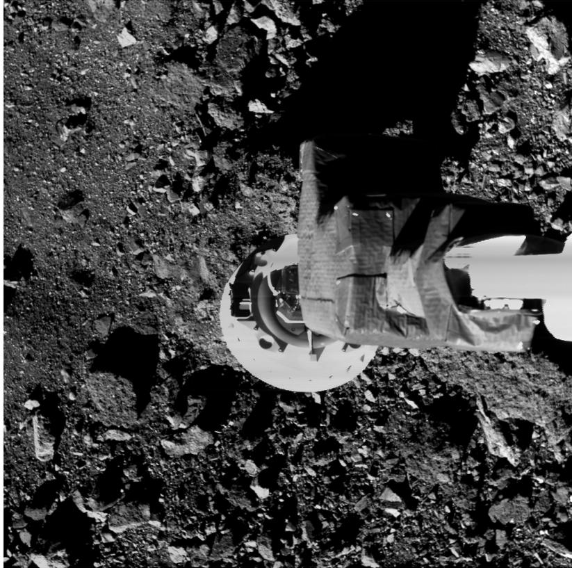
Figure 2.2: Foto della sonda OSIRIS-REx sulla superficie di Bennu.
