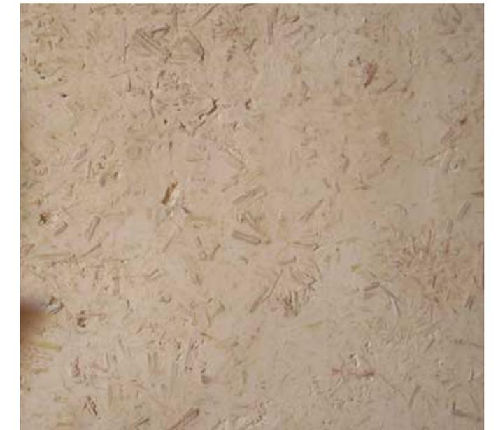
Fig. 94 - Calcecanapa termointonaco della ditta Banca della Calce
