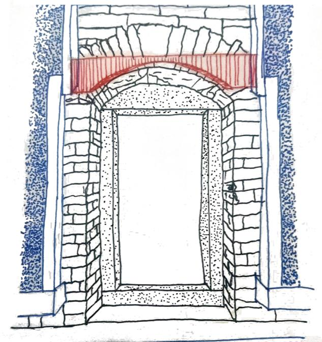
Fig. 105 - Disegno rappresentativo della fase di fissaggio dell'asse di legno.
