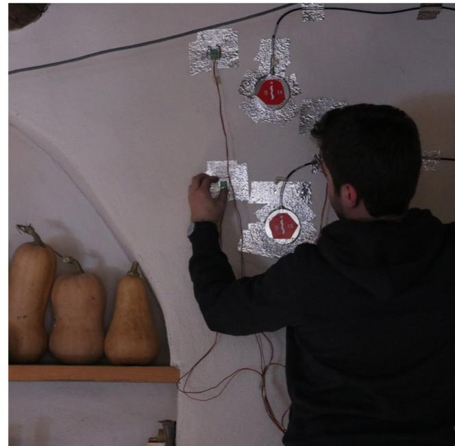
Fig. 50 - Foto di del poizionamento dei sensori per il rilevamento delle trasmittanze per la ricrca di Bocco-Consoli-Raimondi. Lato Nord. (Foto di Maurizio Cesprini)
