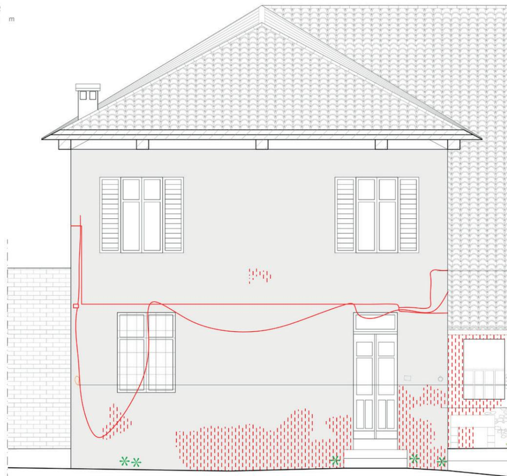
Intonaco con componente cementizia, incompatibile
