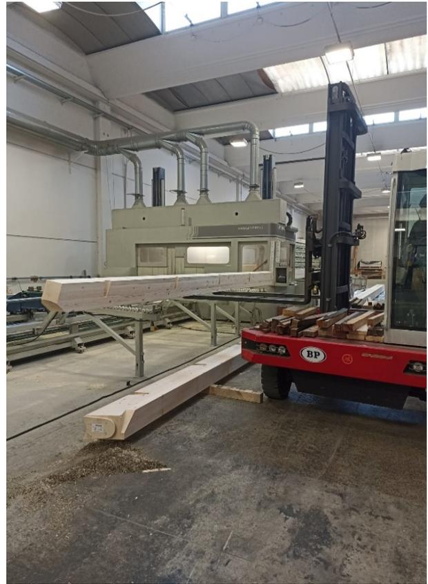
Figura 37: Macchina CNC sullo sfondo e Cantonali già lavorati in legno lamellare in primo piano. (Abitare. Case e strutture in legno).
