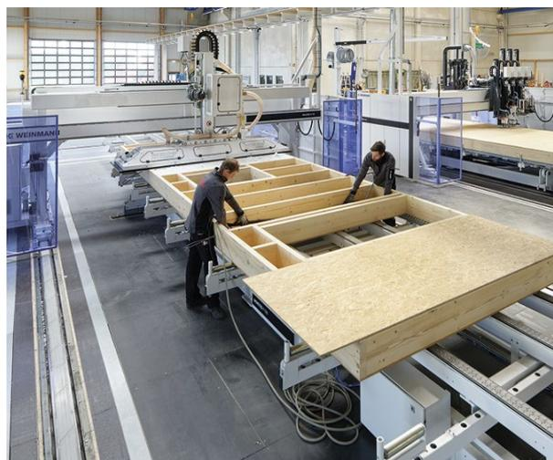
Figura 65: Montaggio pareti in fabbrica. Linea di produzione per pareti (Homag)
