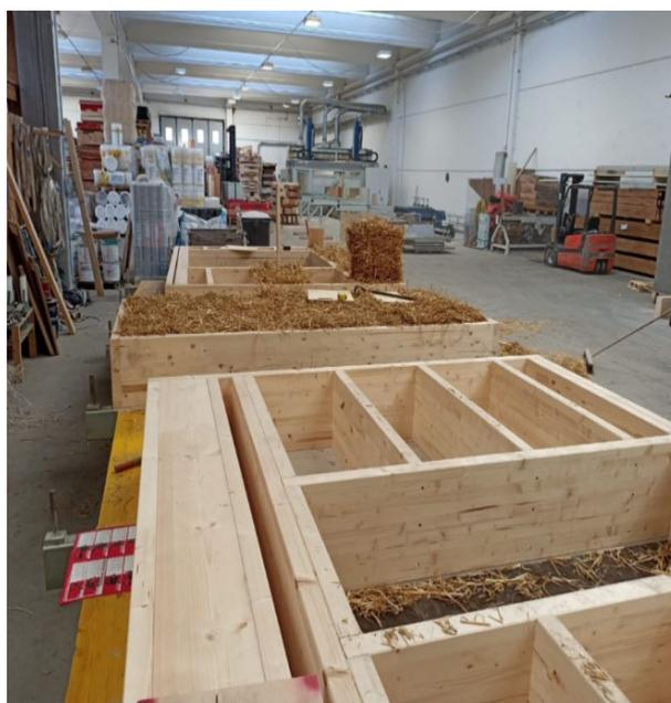
Figura 40: Processo di montaggio di pareti a telaio con l'impiego di balle di paglia come isolante interno. La sezione dei montanti in questo caso è 6x40 cm. (Abitare.Case e strutture in legno)
