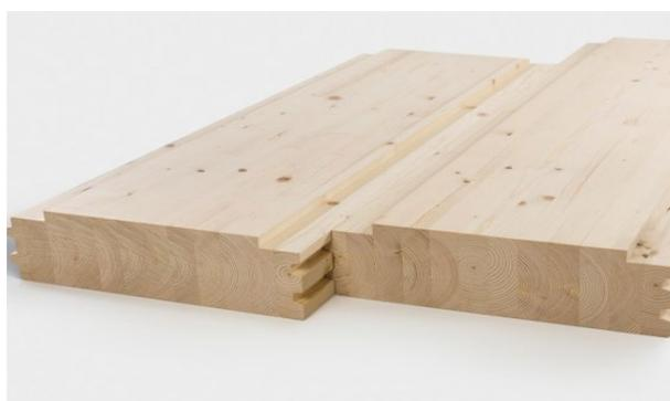
Figura 46: Lamellare sdraiato impiegato per la realizzazione di solai rigidi. Presenta sagomature nei lati e una superiore dove inserire un elemento d'irrigidimento. Hasslacher, "Elementi per solaio in lamellare".
