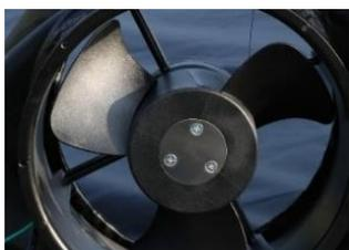
A completamento dell'essiccatore è presente un sistema di ventilazione costituito da una ventola alimentata da un pannello solare, che garantisce il ricircolo dell'aria e la fuoriuscita dell'umidità dal tunnel.
