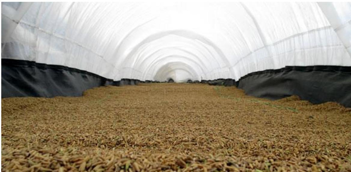
*Tunnel dell'essiccatore Bubble visto dall'interno con riso disposto per l'essiccazione.*
