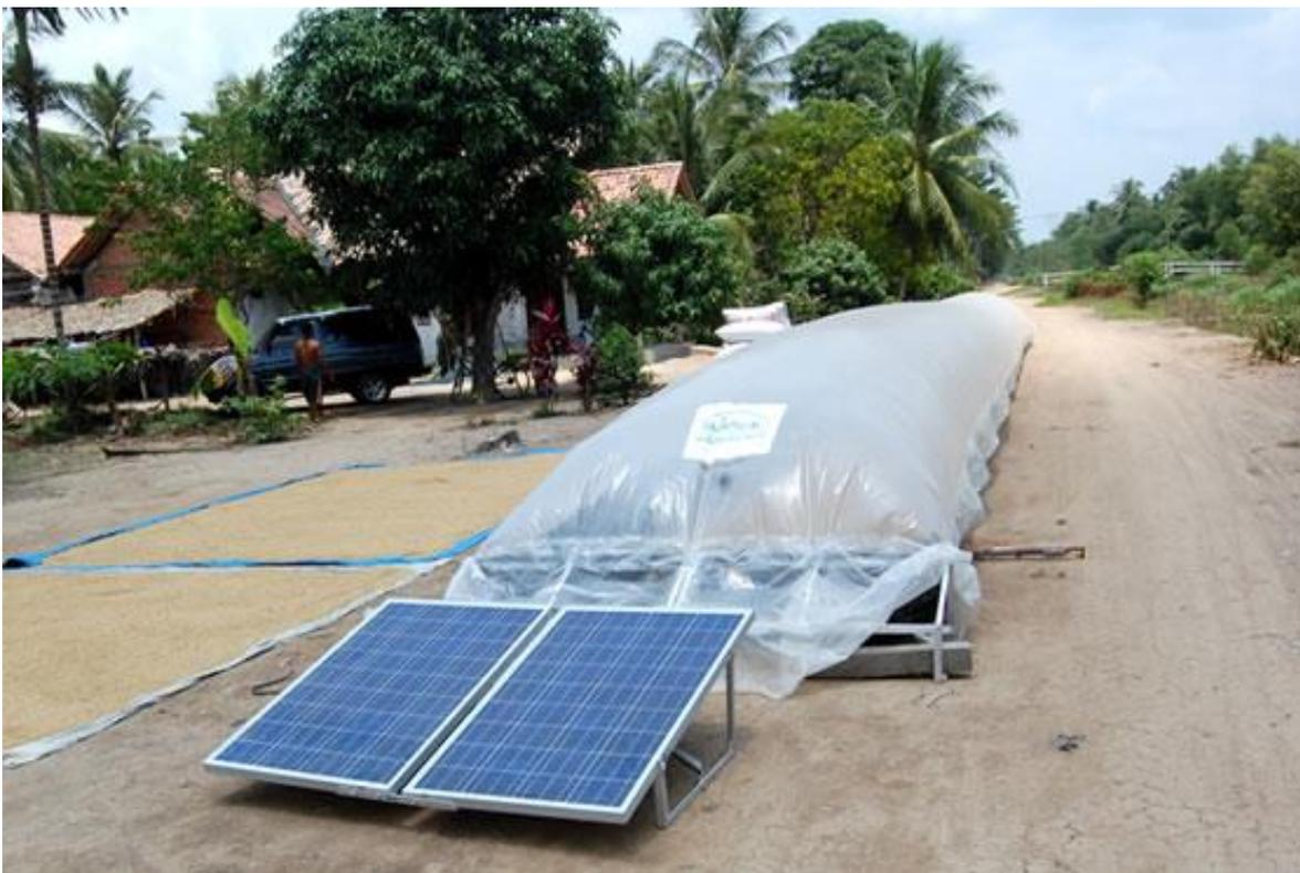
*Essiccatore solare a tunnel Bubble*
