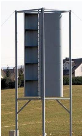
Il Savonius è un tipo di turbina eolica ad asse verticale inventata nel 1925 da Sigurd Savonius, un ingegnere finlandese. Presenta due o tre pale chiuse sopra e sotto da una base circolare, viene impiegata generalmente per il sollevamento di acqua da pozzi o bacini. È un dispositivo che è stato largamente diffuso per la sua predisposizione all'auto-costruzione, ci sono diversi esempi di questo tipo di mulino costruiti artigianalmente.
