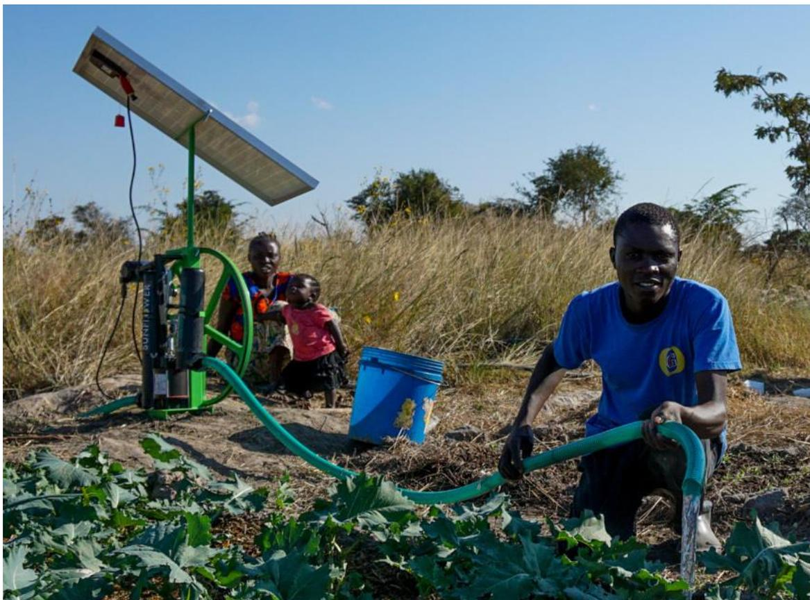
*Pompa solare Sunflower alimentata da pannello solare e collegata a un impianto di irrigazione. (iDE Global)*
