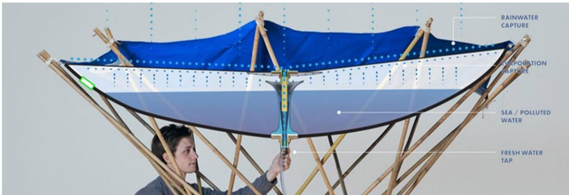
Il **meccanismo interno** per catturare e distribuire l'acqua distillata consiste in una sorta di imbuto, fissato al telo superiore, che raccoglie le gocce condensate di acqua purificata e le incanala in un tubo attraverso cui fluisce l'acqua purificata che viene poi raccolta in una tanica sottostante il distillatore. Sotto l'imbuto è presente un rubinetto che permette di bloccare il flusso.
