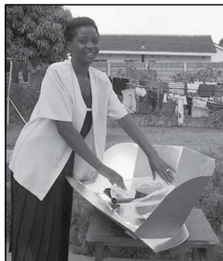
CooKit è un fornello solare, cioè uno strumento che permette di cuocere gli alimenti con l'energia solare. È uno strumento molto semplice da costruire e utilizzare, è economico e portatile. Esposto al sole permette di cuocere cibo per 5-6 persone in poche ore. Grazie
