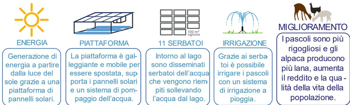
Schema del sistema di irrigazione.
