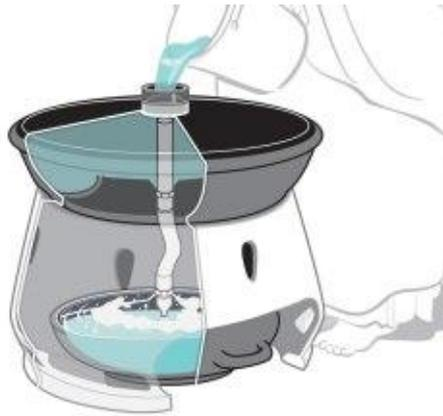
Il distillatore è composto da: un contenitore in cui viene versata l'acqua da depurare, un tubo per convogliare l'acqua purificata nella bacinella di raccolta, la bacinella di raccolta e il corpo che contiene tutti gli elementi.
