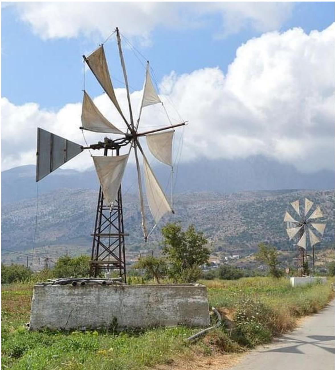
*Molino a vento di tipo cretese per il pompaggio di acqua e l'irrigazione.*
