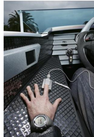
*Sensore per il rilevamento di parametri biometrici.*
