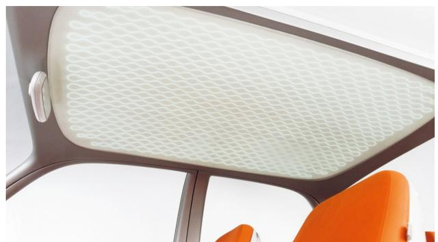
*Dettaglio interno del tettuccio con le fibre ottiche per l'illuminazione degli interni.*
