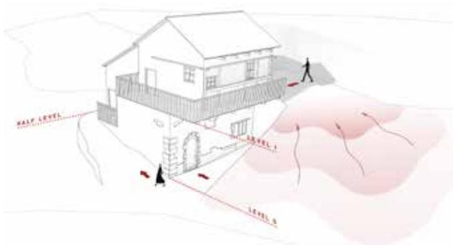
FIG.2.4 - Accesso ai diversi livelli dell'abitazione tramite l'uso di rampe o sfruttando le pendenze del terreno (Alta Valle).
