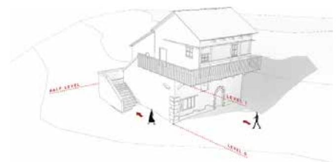
FIG.2.5 - Accesso ai diversi livelli dell'abitazione tramite l'uso di scale esterne e balconi (Bassa Valle).
