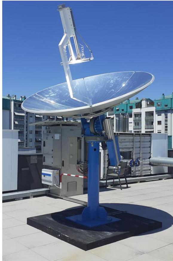
Figura 51- Concentratore parabolico a disco dell'Energy Center
