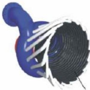
Figura 24- Schema di un ricevitore a cavità [39]
