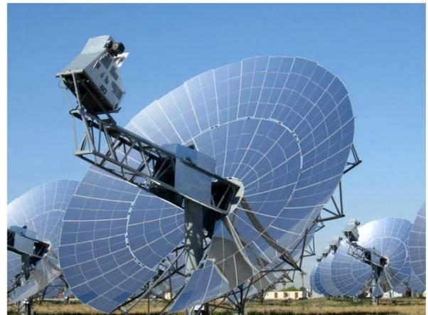
Figure 17 e 18- Esempi di collettori a disco parabolico con motore Stirling [34] [35]
