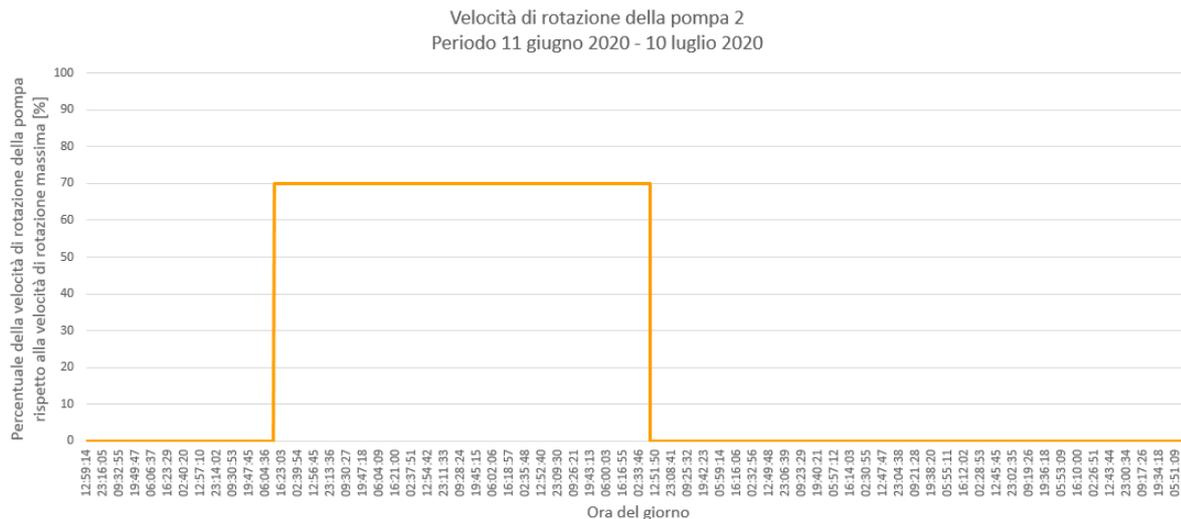
Figura 59: andamento della percentuale di velocità di rotazione della pompa 2 rispetto alla velocità di rotazione massima di funzionamento nel periodo 11 giugno 2020 - 10 luglio 2020
