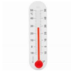
*Figura 47 - Esempio di termometro a dilatazione di liquido*
