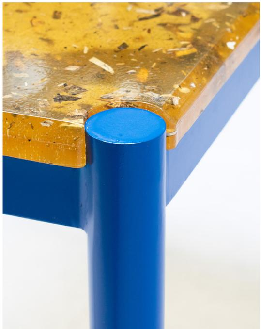
Tavoli *Autunno* con top realizzato con pannelli grandi (250 x 125 cm) in bioplastica tagliati, lucidati e fissati ad una struttura in ferro verniciato. L'operazione di lucidatura di questo pannello è sperimentale e prevede di passare velocemente la fiamma ossidrica sulla superficie, in modo da fonderla leggermente ed eliminare le imperfezioni.
