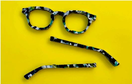
Montatura per occhiali ricavata tagliando il pannello a CNC e successivamente assemblata con viti.
