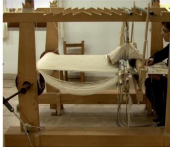
**Fig. 3.1** Telaio orizzontale
