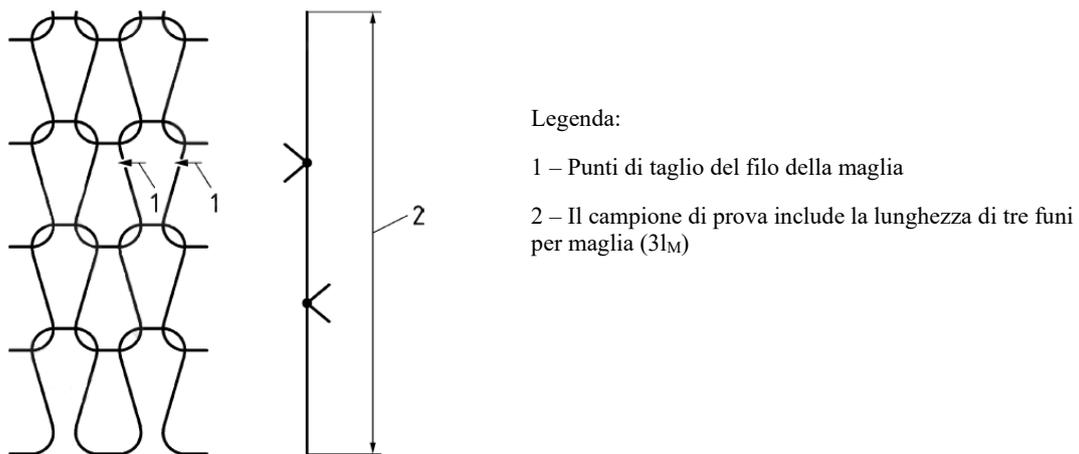
**Figura 1.17.** Campione di prova – UNI EN 1263-1:2015.
