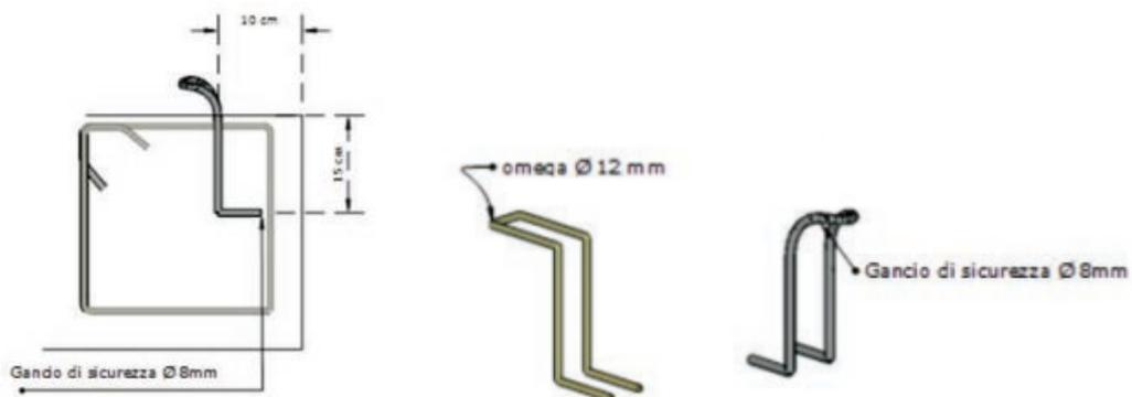
**Figura 1.15.** Particolare omega e gancio di sicurezza – INAIL.
