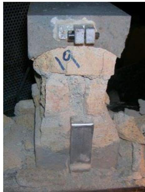
Figura 92 - Materiale composito: Provino a seguito della prova di compressione
