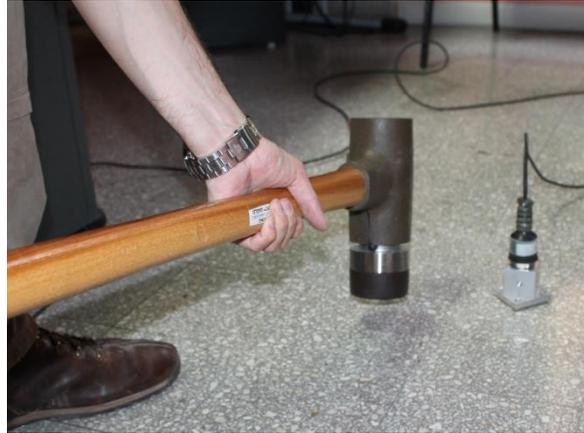
Figura 132 – Martello dinamometrico
