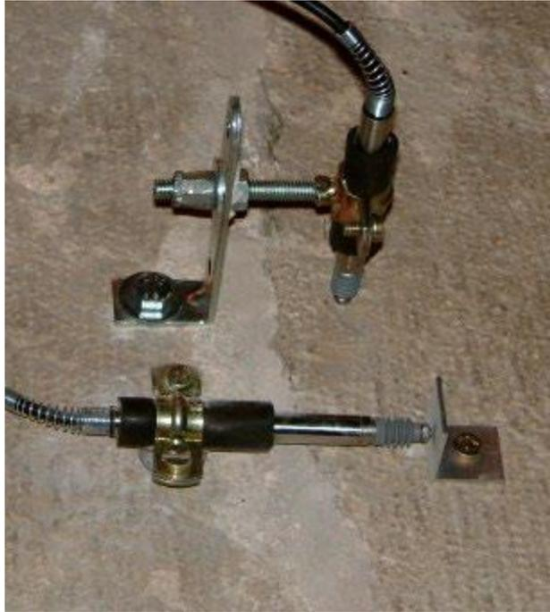
*Figura 125 – Estensimetri combinati*
