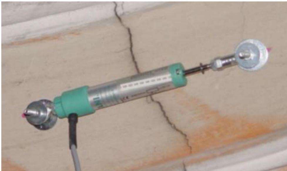
Figura 124 - Trasduttore di spostamento potenziometrico
