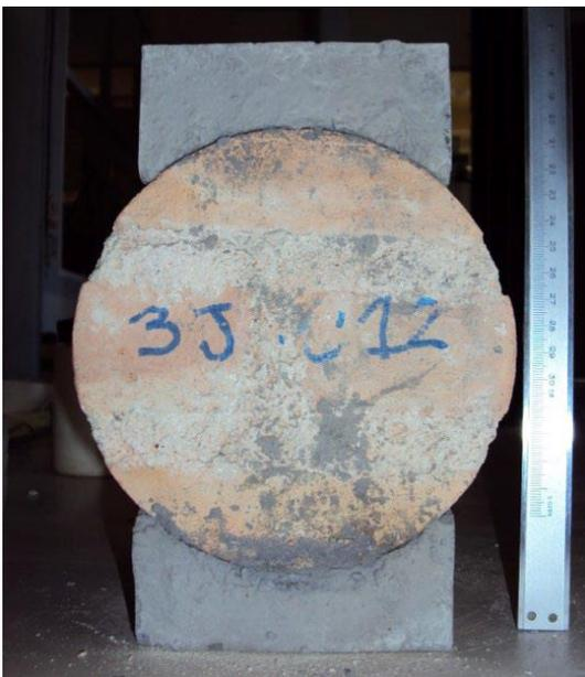
Figura 91 - Materiale composito: Provino pronto per la prova di compressione
