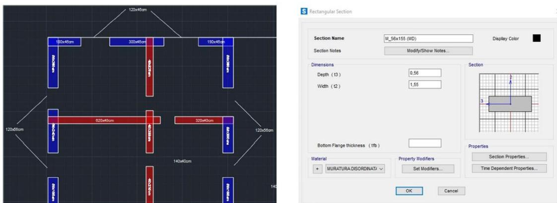
Figura 245 - Sezioni degli elementi strutturali
