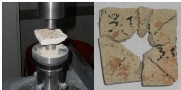
Figura 85 - Malta: prova di punzonamento
